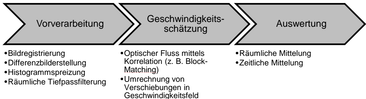
Abbildung 4.2: Schematische Darstellung der Bildverarbeitungsschritte
