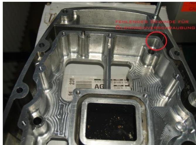
Abbildung 14 Fehlende Verschraubung
