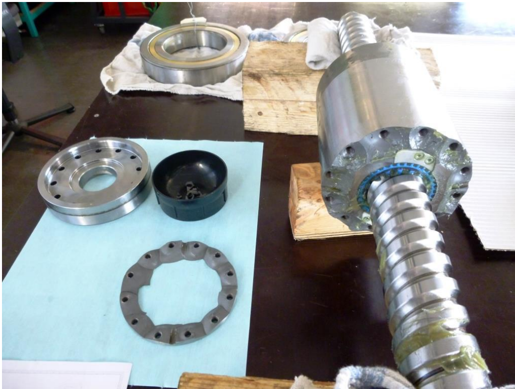
Abb. 11: Bruch der Mutter bei Hochlastversuchen
