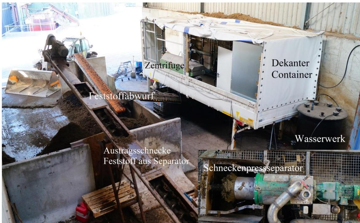
Abbildung 2.2: Versuchsaufbau der Fest-/Flüssigseparation durch Schneckenpresseseparator und Dekanterzentrifuge (Beispiel: Standort 1)
