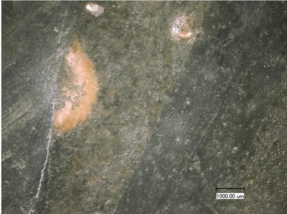
Bild 86: Innenseite, intakte Flächenimprägung auf DM7
