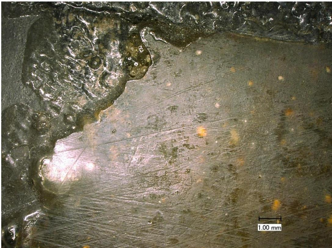
Bild 77: Innenseite, intakte Flächenklebung auf DM1
