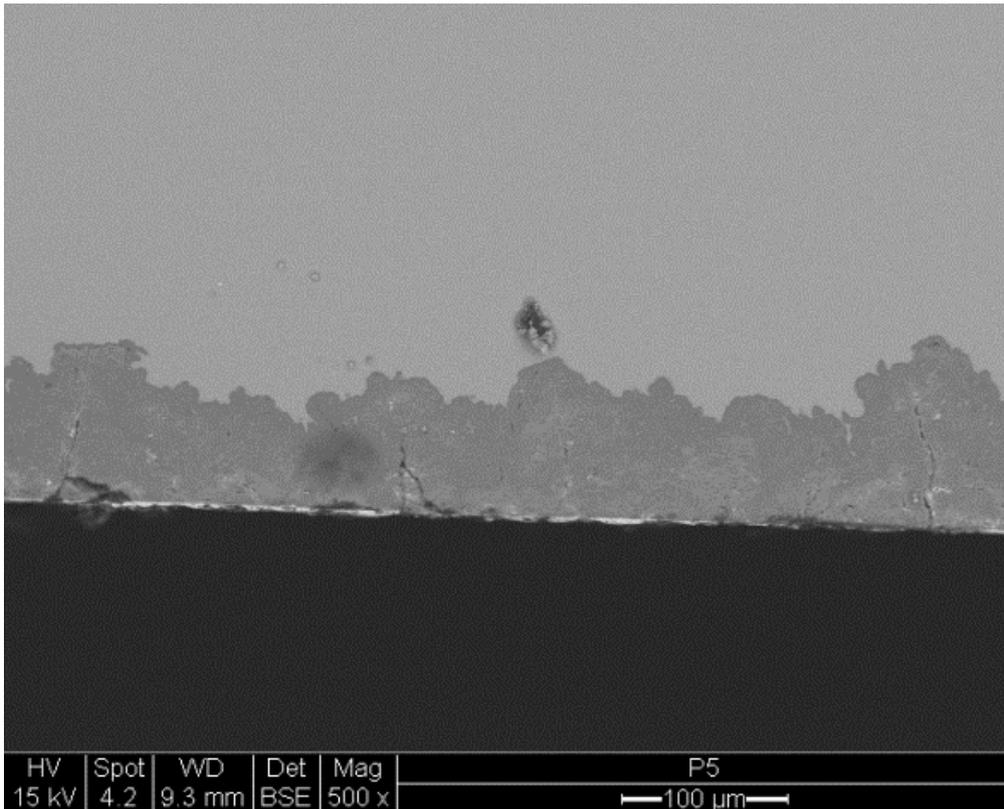
Bild 148: Gelschichtbereiche an der Innenseite von Glas P5 im Ausgangszustand
