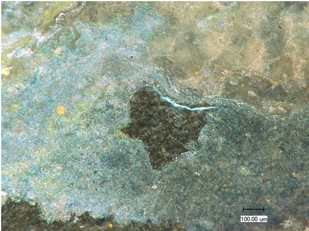
Bild 45: PG 3: Feld nIX 3b; Innenseite, defekte Beschichtung auf Schwarzlot (Polyvinylacetat/Silanhaftvermittler oder Polymethylmethacrylat?)
