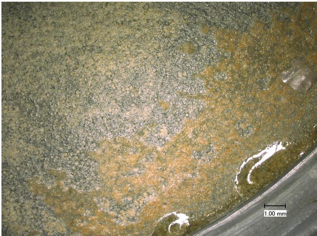
Bild 89: Außenseite, Beschichtungsmaterial und Flächenimprägnierung auf DM1
