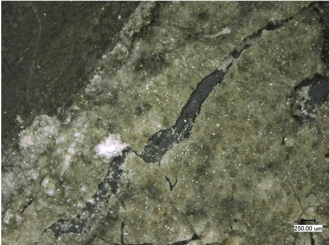
Bild 16: Feld 15B- Außenseite, lockeres Material (hell) auf T7, Probe für FTIR/ESEM
