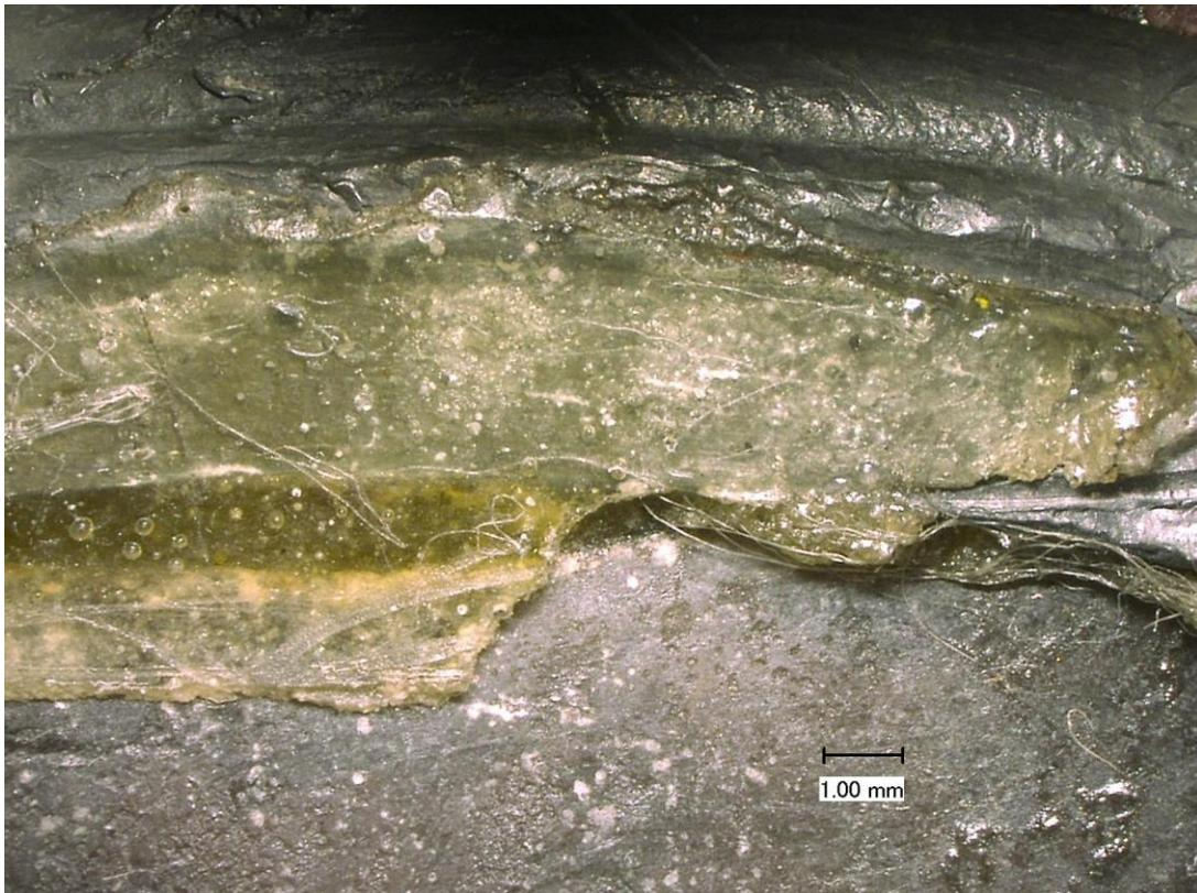
Bild 57: Innenseite, dicke Flächenklebung auf KM2
