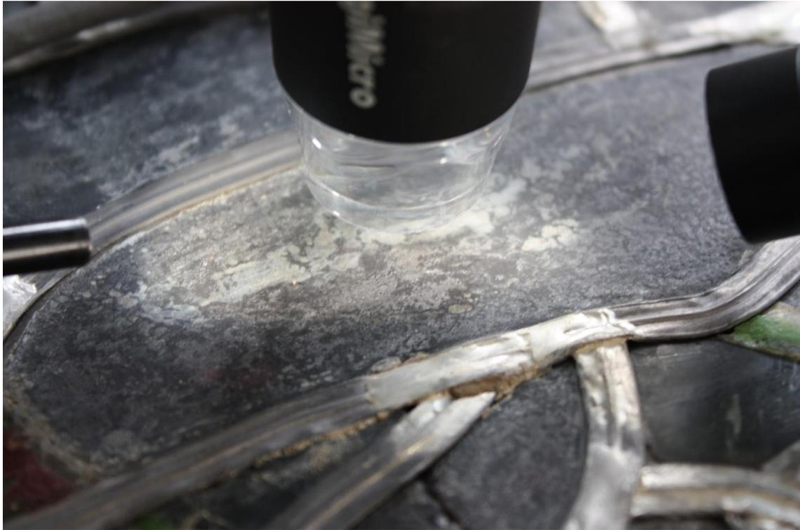
Bild 28: PM1: Feld nIX 6b; Außenseite, grauer Oberflächenbelag, Probenahme mit Skalpell
