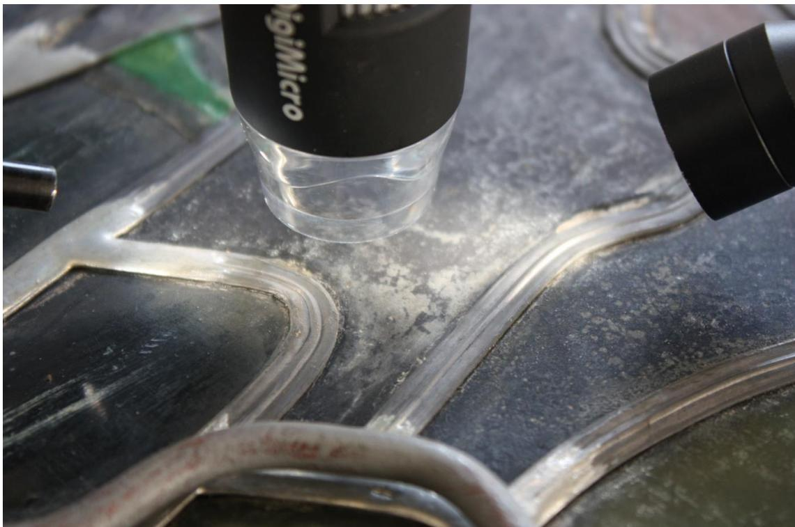
Bild 29: PM2: Feld nIX 6b; Außenseite, grauer Oberflächenbelag, Probenahme mit Skalpell
