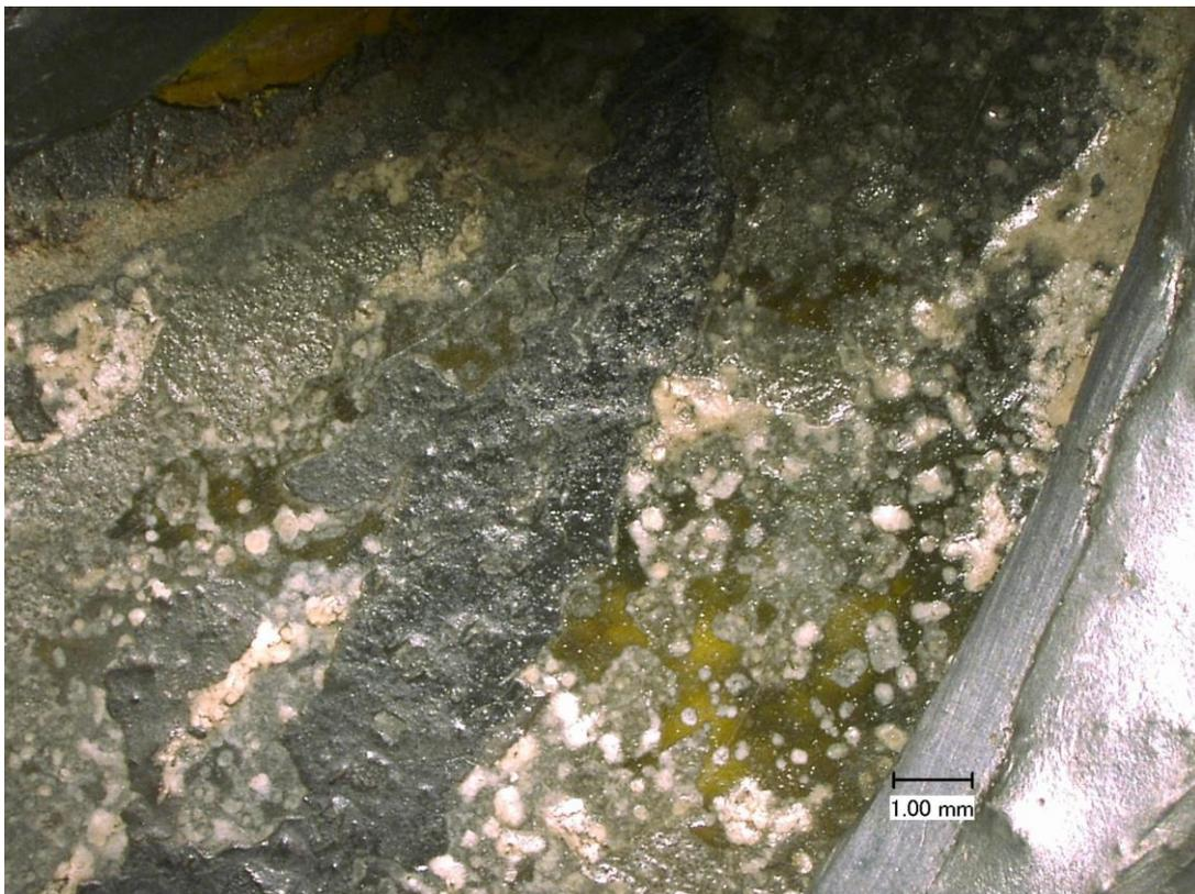
Bild 55: Innenseite, Beschichtungsmaterial auf korrodiertem Glas und Schwarzlot auf KM1
