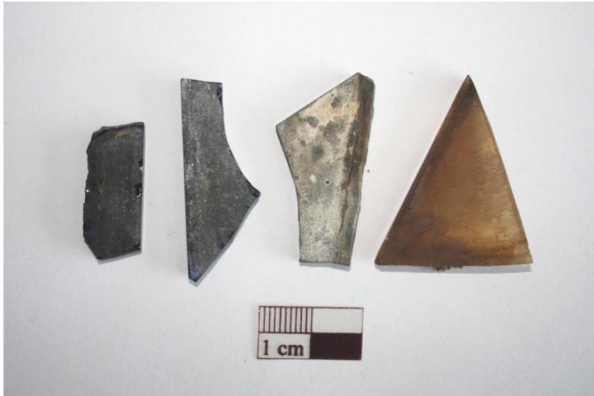
Bild 100: Glasproben für analytische Untersuchungen P1, P2, P3, P4 (von links nach rechts)
