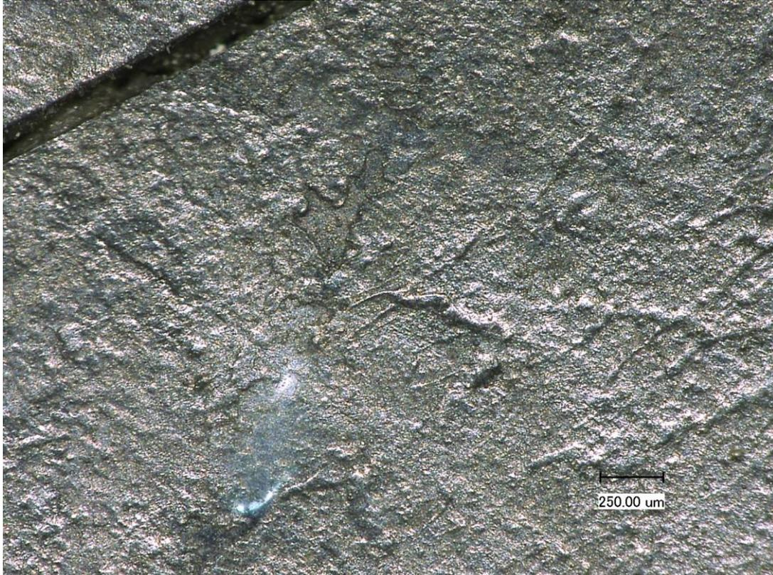
Bild 62: Innenseite, Detail - Flächenimprägierung auf KM4
