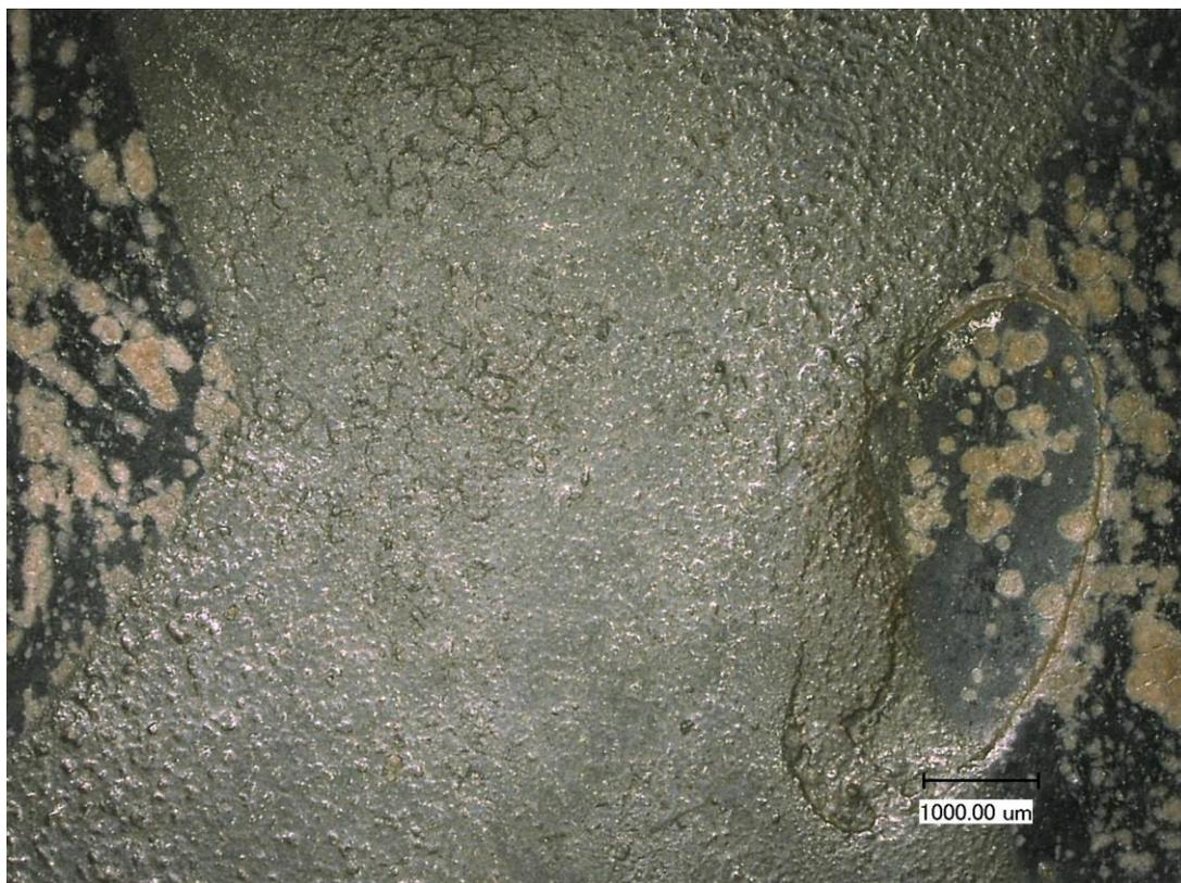
Bild 75: Innenseite, Detail- Beschichtungsmaterial auf Schwarzlot auf DM1
