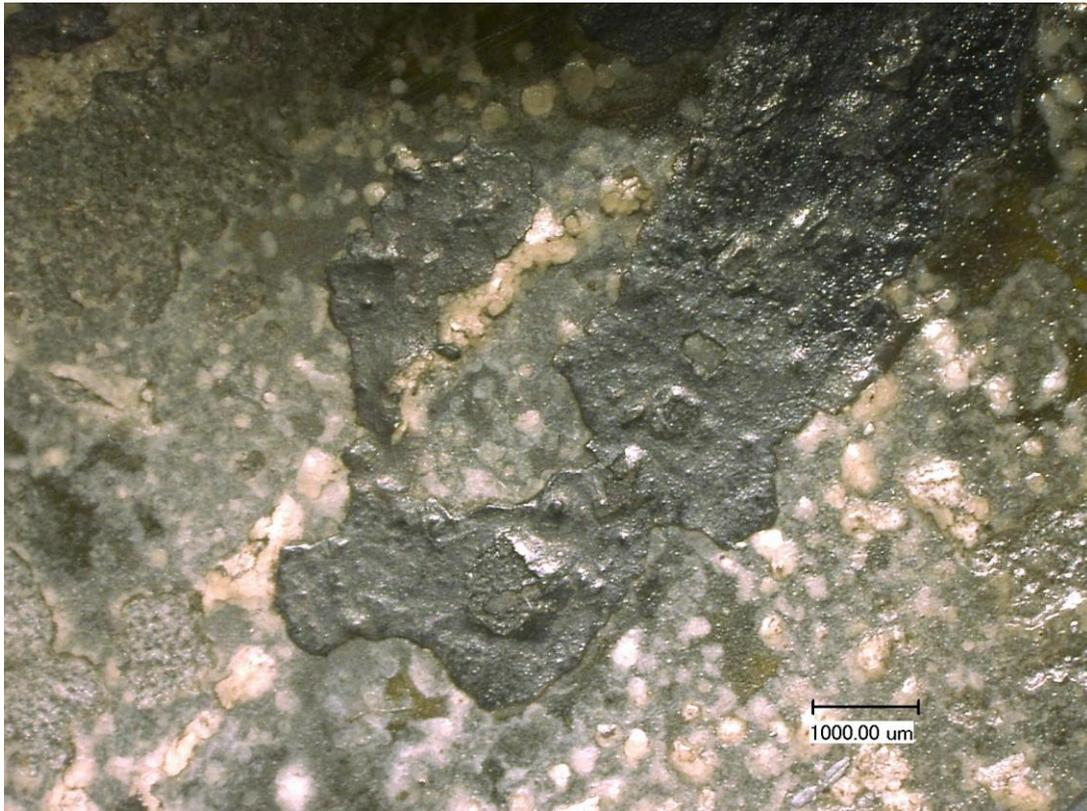
Bild 56: Innenseite, Detail - Beschichtung auf Glasoberfläche und Schwarzlot auf KM1
