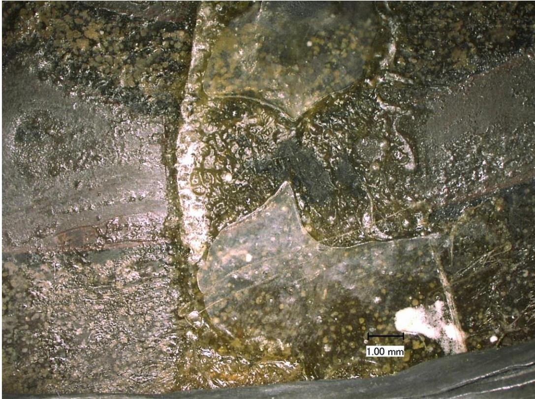
Bild 60: Innenseite, Detail – relativ dickes Beschichtungsmaterial auf Schwarzlot und Glas auf KM3
