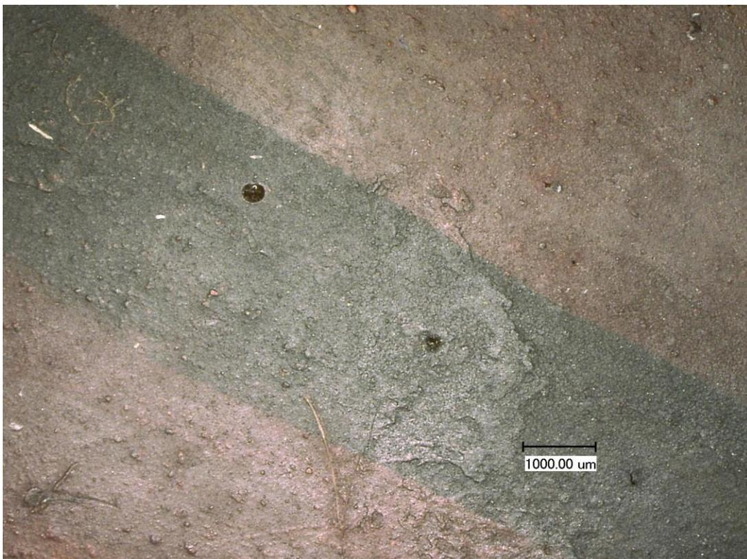
Bild 65: Innenseite, Flächenimprägnierung von Schwarzlot und Glasoberfläche auf KM6
