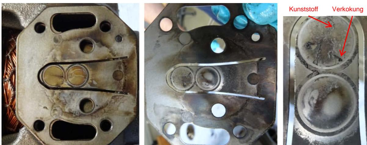
**Abbildung 15 – Vergleich der Ventilplatte vor und nach dem Dauertest**
