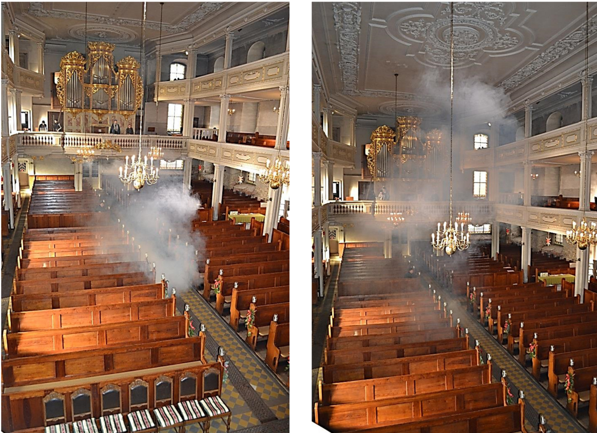
Abb. 55 Nebelversuch nur Visualisierung von Luftbewegungen links: ca. 10 sec. nach Nebelaustritt, rechts: ca. 30 sec. nach Nebelaustritt
