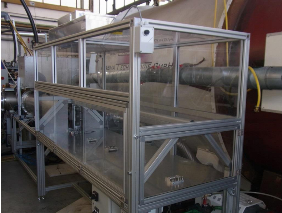
Abbildung 23 Einhausung mit FFU
