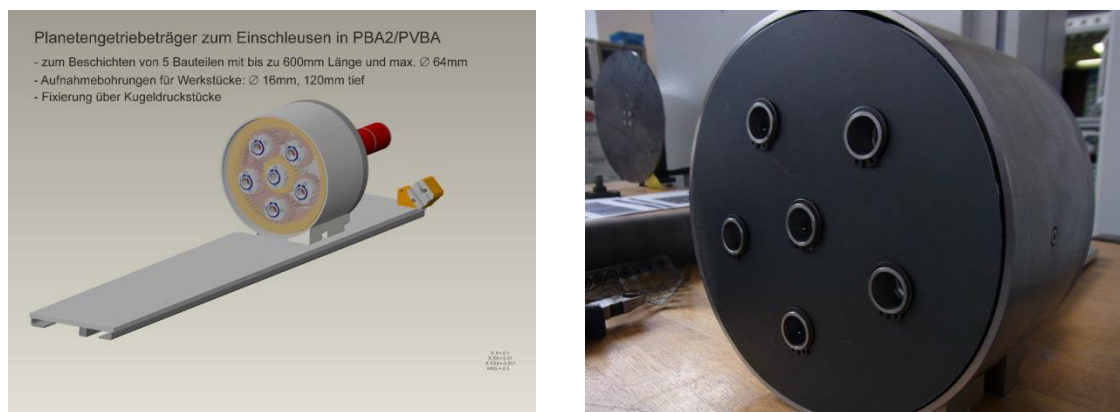
Abbildung 78 Technisches Konstruktion und realisierte Vorrichtung zur Abscheidung von Silicium als Bulkmaterial aus dem Plasmastrahl
