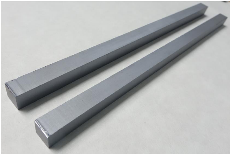
Abbildung 79 Silicium-Stäbe aus multikristallinem Silicium zum Einsatz als „Seelen“ im Plasmaverfahren
