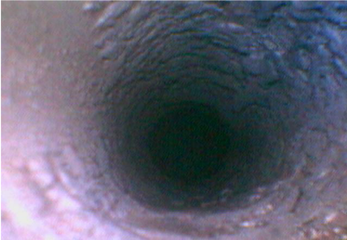
Abbildung 51 Blick in den Plasmagenerator nach Siliziumherstellung mit ausreichend Plasmaleistung
