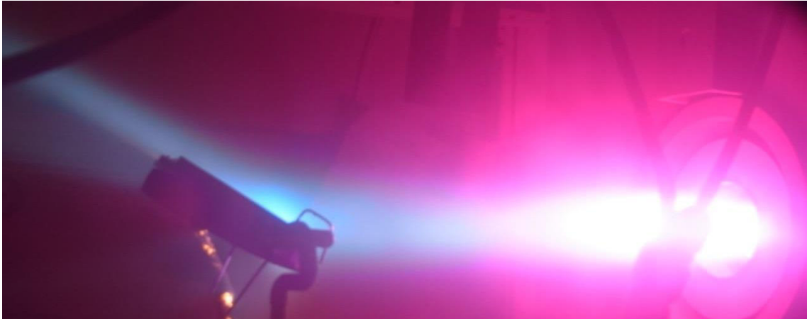
Abbildung 24: PBA2-Plasmaströmung mit Staukörper
