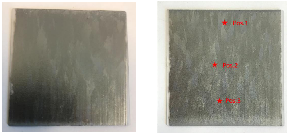
Abbildung 75: Fotos der umgeschmolzenen Proben HP-Q 2 (links) und HP-Q 3 (rechts); die Prozess-Richtung des ZMR-Prozesses ist in den Fotos von oben nach unten
