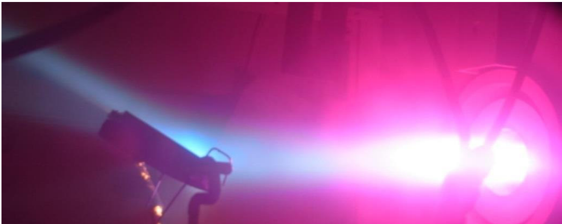
Abbildung 27 Plasmastrahl bei p = 2,1 mbar
