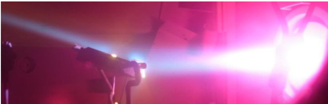
Abbildung 29 Plasmastrahl bei p = 3,5 mbar
