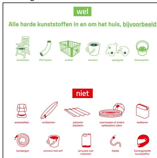
Bild 26: Liste 1 zur Kunststoffsortierung in verwertbare und nicht verwertbare Fraktionen; die grün gefärbten Produkte eignen sich für ein werkstoffliches Recycling (Labots, 2015) (17)
