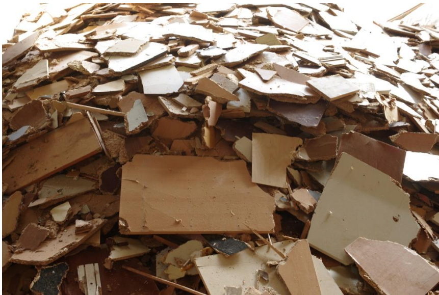
Bild 17: Baggergebrochene Holzfraktion (sortierte Spanplatten)
