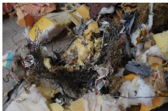
Bild 41: Zerkleinerte Polsterfederstrukturen – hier Metall (Konstruktionselement Polstermöbel) Nestbildung mit Anhaftungen
