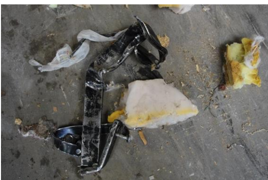
Bild 40: Freigeschlagenes Metallobjekt – hier Metall (Konstruktionselement Möbel) mit PUR-Schaumrestanhaftung
