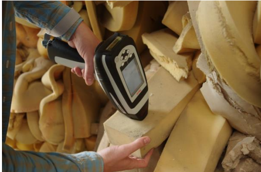
Bild 57: Kunststofferkennung mittels Handmessgerät.
