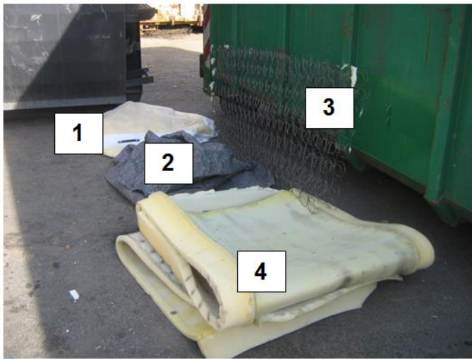
Bild 55: Matratzenkonstruktionsmaterialien nach Matratzenzerlegung
