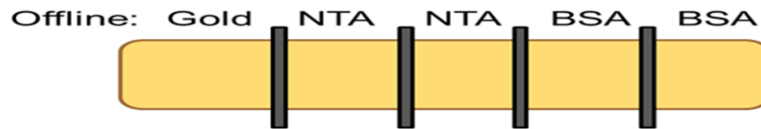
Fig. 9: Beschichtung der einzelnen Kanäle der Chipoberfläche. Linker - C2-Dithiobis-NTA 1 mM in H 2 O, Referenzflächen - BSA 1 mg/ml; reine Goldoberfläche, Blockierungslösung - BSA 1 mg/ml in HEPES pH 6.9, Aktivator - NiSO 4 0,03 M in H 2 O, His-Tag Peptid - Au-Aga1p, Messprobe - AuCl 3 (0,1 mM, 19,6 µg Gold/ml).
