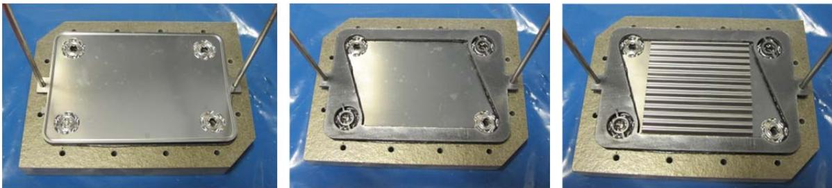
Abbildung 3-2: Montageablauf Reformer mit Wärmeübertragerblech (links), Graphitdichtung (Mitte) und eingelegtem Wellblech (rechts), hier am Beispiel einer Wärmeüberträger-Stufe, seitliche Führungsstifte zur einfachen Montage
