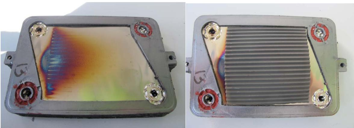
Abbildung A-16: Wärmeübertragerblech (links) nach Demontage mit thermisch bedingten Verfärbungen und Verformungen, Wellblech mit Brennerkatalysator (rechts) nach dem Versuch des Skalierten Reformers über 50 Stunden
