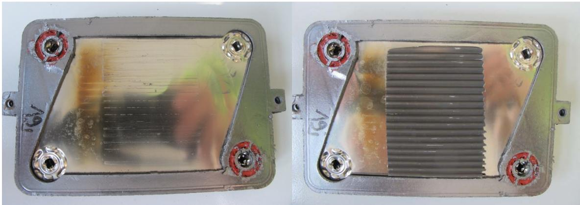
Abbildung 3-34: Wärmeübertragerblech (links) nach Demontage mit thermisch bedingten Verfärbungen und Verformungen, Wellblech mit Reformierkatalysator (rechts) nach dem Versuch, Abdichtung des Bereiches um die Bohrungen links oben und rechts unten
