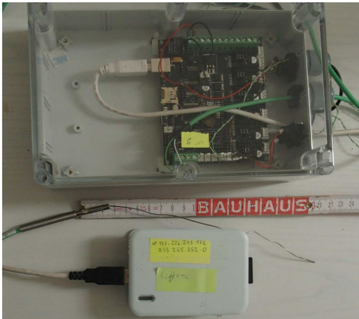
Abbildung A-12: Microcontrollersteuerung mit Visualisierungsrechner
