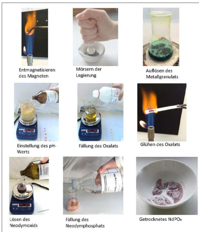
Abb. 9: Einzelne Stufen der Rückgewinnung von Neodym aus einem Handlautsprecher
