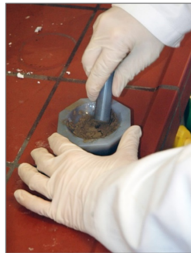
Abb. 6: Mörsern der Substanzmischung zur Herstellung des YBCO Supraleiters
