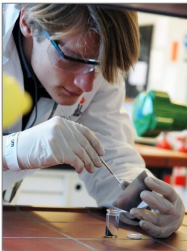
Abb. 6: Mörsern der Substanzmischung zur Herstellung des YBCO Supraleiters
