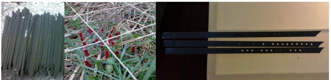
Abbildung 5: Veranschaulichung der Methodik zur Bestimmung der Aktivität von Bodenorganismen. Foto links: fertig mit Ködermasse gefüllte Köderstreifen warten auf ihren Einsatz, Foto Mitte: Die Stäbe wurden für 14 Tage in den Oberboden eingestochen. Zu sehen ist eine sogenannte Basisgruppe, Foto rechts: Direkt im Anschluss werden die Streifen auf ein Durchlichtpult gelegt und herausgefressene und unberührte Köder werden ausgezählt.
