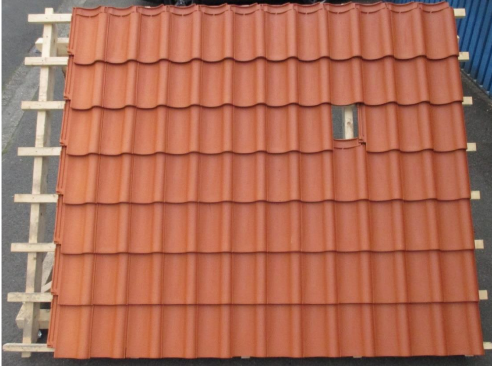
Abbildung 37: Naturroter Dachziegel aus dem Enviro Versuchsofen
