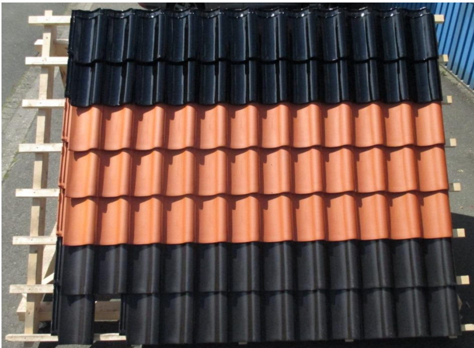
Abbildung 36: Verschiedene Dachziegelarten aus einem Brennversuch
