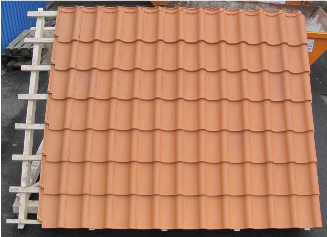
Abbildung 20: Mit im Enviro gebrannten Ziegeln bedecktes Dach
