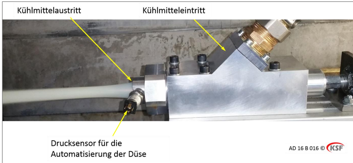
Abb. 5: Die am KSF gefertigte Ringspaltdüse.
