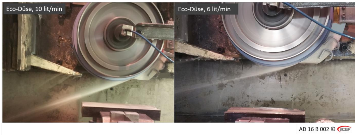
Abb. 18: Testdurchlauf der "Eco-Düse" mit Schleifscheibe.
