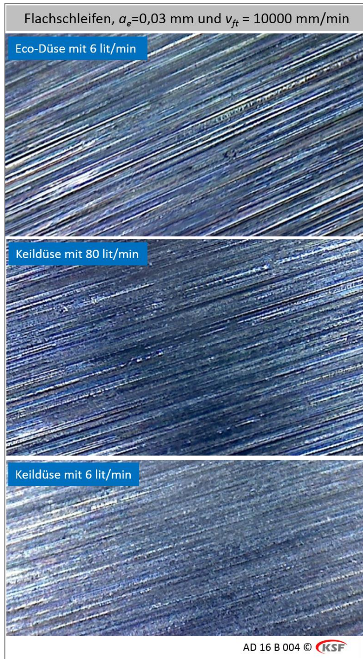
Abb. 22: Oberflächen der Versuchsteile nach dem Tiefschleifen mit den verschiedenen Düsen. Die geschliffene Oberfläche, welche mit der Keildüse mit 6 l/min flachgeschliffen wurde, ist etwas schlechter als die mit der Keildüse mit 80 l/min oder der Eco-Düse mit 6 l/min geschliffene Oberfläche.
