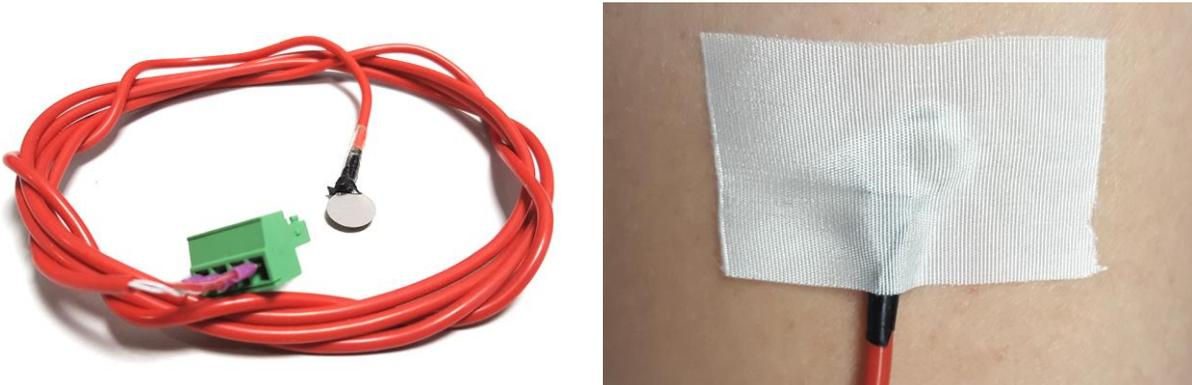
Abbildung 52: PT100 Sensoren werden im EneffThermControl Projekt als Messfühler zur Erfassung der Hautoberflächentemperatur für die Validierung und den Vergleich der Infrarotmessung mit herkömmlichen Messmethoden verwendet (Metzmacher, Wölki, Schmidt, Frisch, & van Treeck, 2017)
