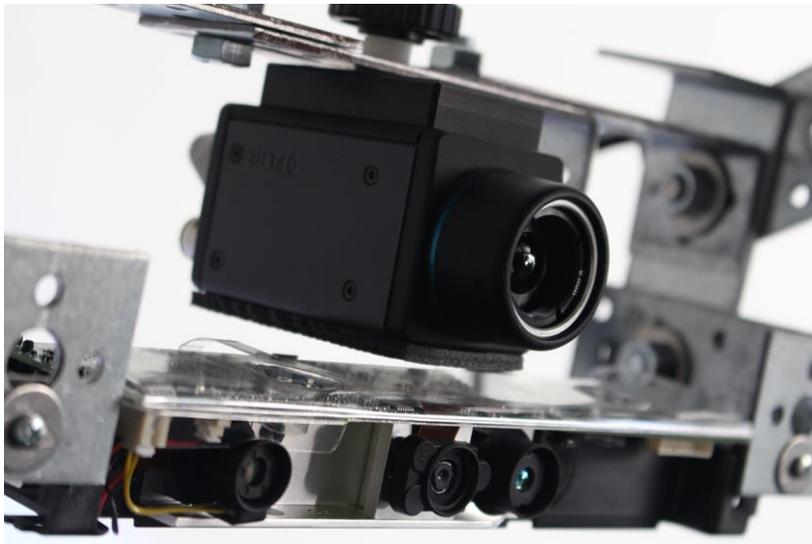
Abbildung 24: Prototyp des Thermografiekamera/Tiefenkamera Aufbaus (Metzmacher, Wölki, Schmidt, Frisch, & van Treeck, 2017)
