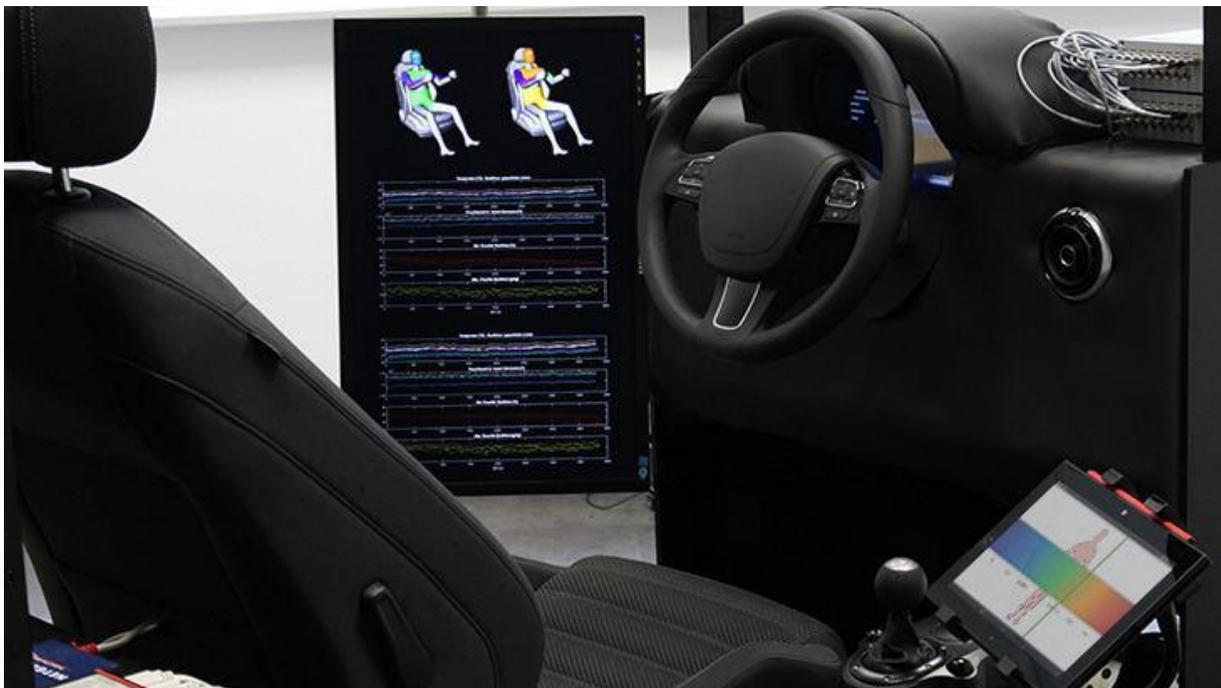
Abbildung 36: Mockup mit integriertem Fahrsimulator, Tablet zur Abfrage der thermischen Behaglichkeit und Echtzeit Monitoring der Messdaten
