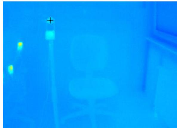
Abbildung 29: Referenztemperatursensor in thermografischer Ansicht. Der Referenztemperaturmesspunkt wurde manuell vom Benutzer gesetzt
