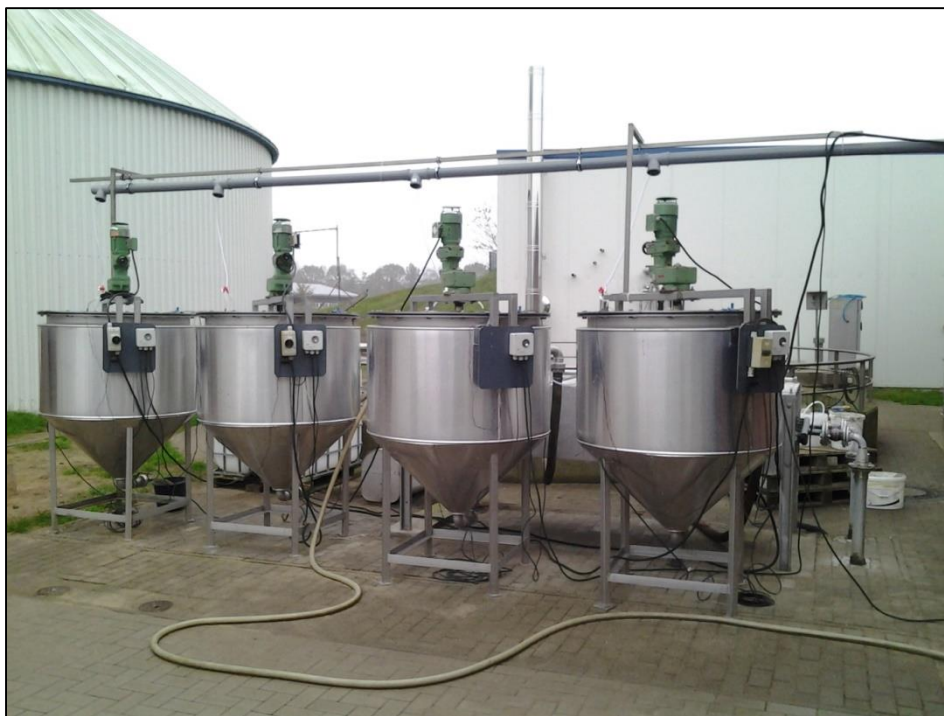
Abbildung 21: Versuchsstand für die halbtechnischen Faulungsversuche
