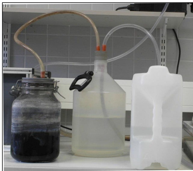
Abbildung 9 Laborfaulbehälter mit Gasspeicher und Auffanggefäß
