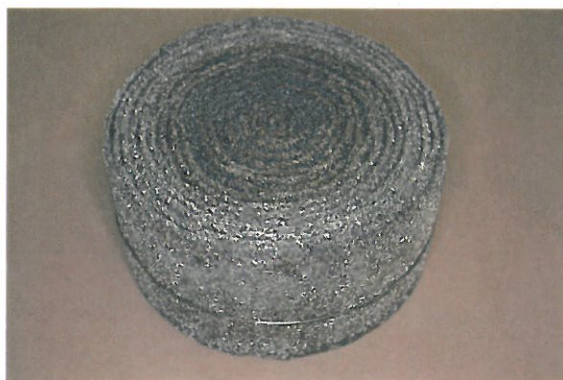
Abbildung 30: Metallschaumprobe mit Palladiumdotierung nach dem Einsatz in der Nachrüstlösung
