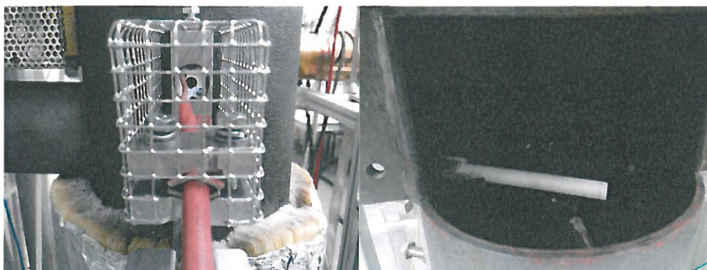
Abbildung 17: HTH-Rohrheizer eingebaute in der Nachrüstlösung; Elektrischer Anschluss (links) und temperaturbeständige Keramikhülle des Heizelementes im Abgasrohr (rechts)
