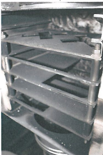
Abbildung 35: Innerer Aufbau der Staubabscheiderbox bei den Untersuchungen mit der Metallwabe als Katalysator
