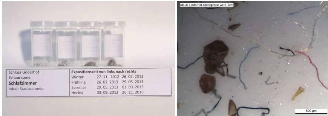
Abbildung 9: Links: Fotografischer Vergleich der Staubsammler im saisonalen Verlauf. Rechts: Aufsicht-Mikroskop-Aufnahme einer Klebprobe.
