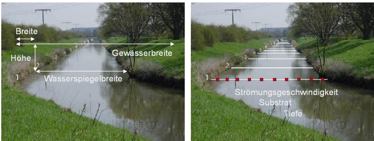
Abbildung 2-3: Schema zur Aufnahme hydromorphologischer Parameter in den Untersuchungsbereichen.
