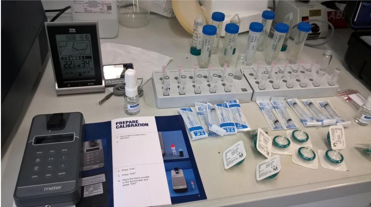
Abbildung 6: Messung der bakteriellen Aktivität mit der Bactiquant-Methode.
