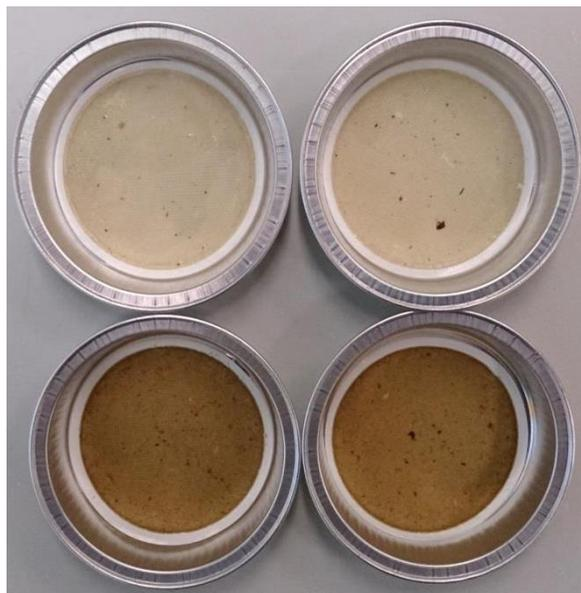
Abbildung 2: Beladene Filter von Wasserproben aus dem Kontroll- (oben) und Belastungskreislauf (unten), jeweils als Doppelproben.
