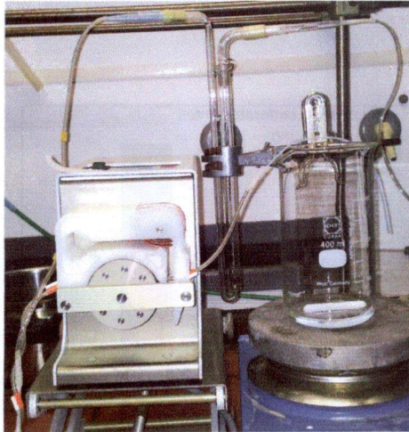
a) Versuchsanlage für Adsorptionsversuch (Füllmenge etwa 3,5 bis 4,0 g Polyamid)
