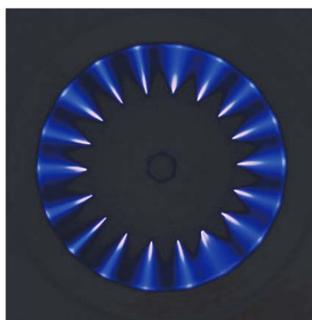
Abbildung 4.9 Prototyp des ITC am KIT (links, Bologa und Woletz, 2014) und Coronaentladung in einem rohrförmigen Reaktor (rechts, Paur et al., 2012)
