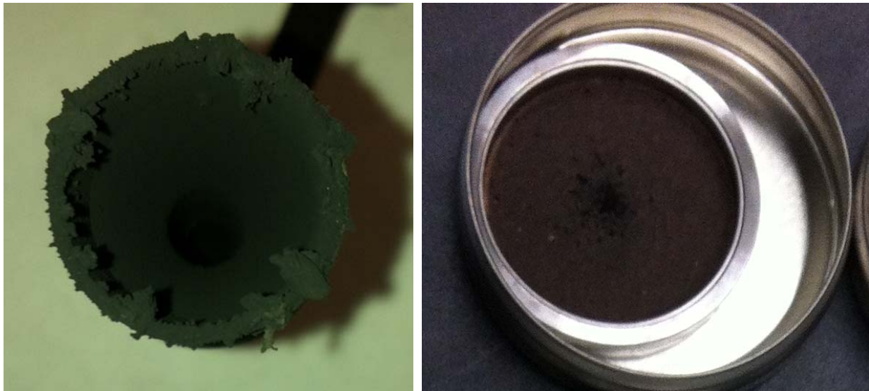
Abbildung 6.1 Staubablagerungen an der Düse der Entnahmesonde für die Staubmessung an Messstelle 2 (links) und zugehöriger Staubfilter mit Staubagglomeraten
