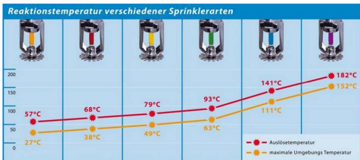
Bild 17 Auslösetemperaturen von Sprinklern (Quelle: URL: http://www.fire-protectionsolutions.com/cms-produkte-brandschutz-feuerschutz/sprinkleranlagen , 26.01.2014)
