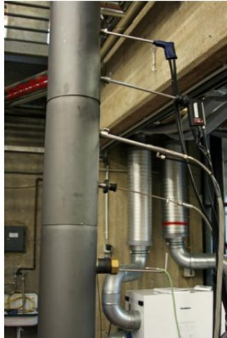
Abbildung 12: Messstellen am Abgasrohr (Prüfstand Dülmen).
