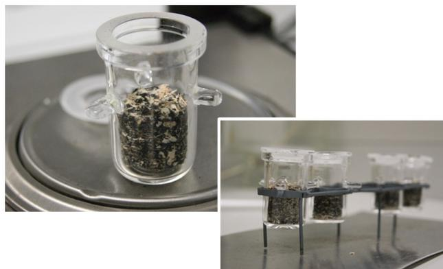
Abbildung 13: Messaufbau zur Bestimmung der Flüchtigen Anteile.
