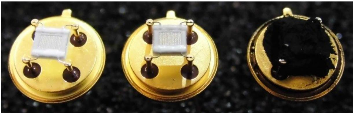
Abbildung 15: Optischer Vergleich der Sensoren. Links: Unbeladen; Mitte: Leicht beladen (response 3 %), Rechts: Stark beladen (response 419 %, Perkolationsschwelle überschritten) [32].
