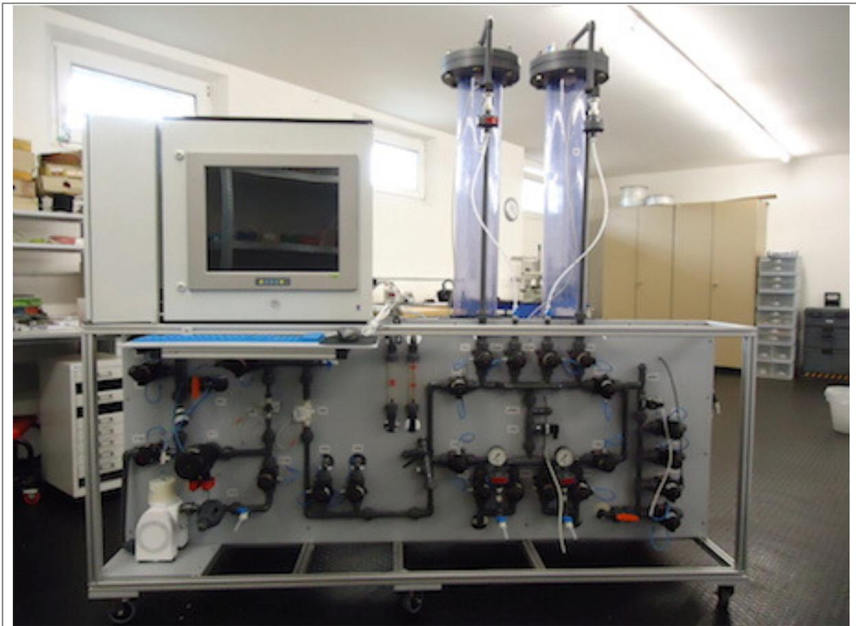
Abb. 16 *Pilotanlage zur Wolfram-entfernung und Badpflege*
