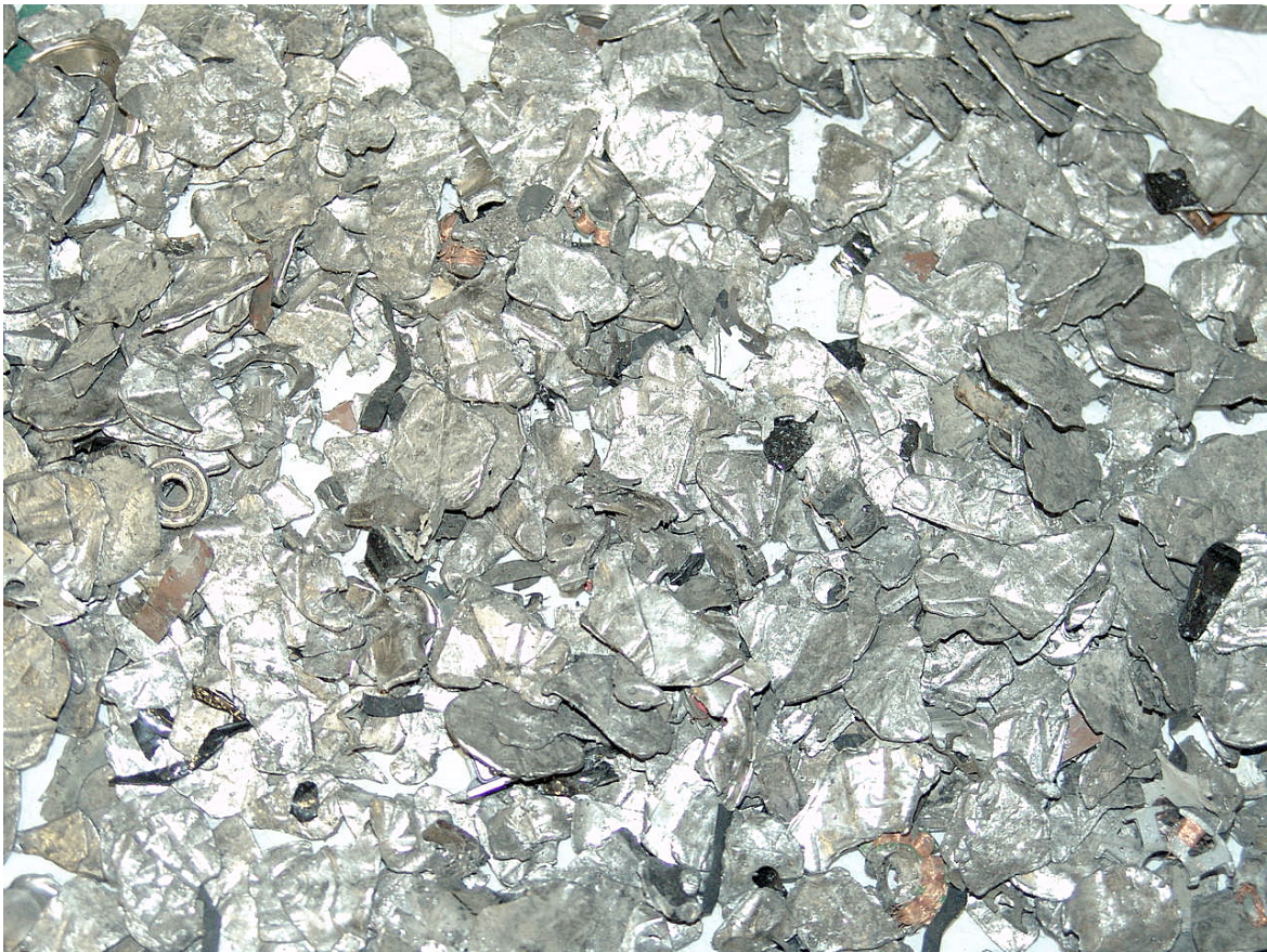
Abbildung 1 Fließbild und Magnetfraktion aus mechanischer Aufbereitung
