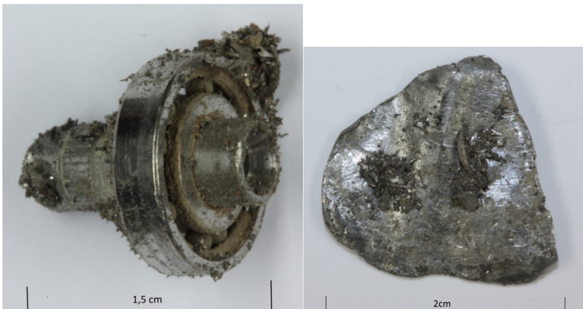
Abbildung 10 Magnetpartikel auf ferromagnetischen Werkstoffen
