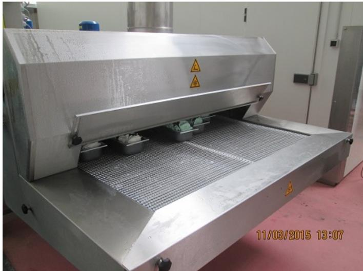
Abbildung 17: Austrittsbereich des Stickstofftunnels
