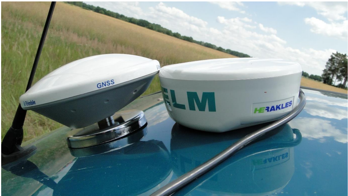
Abbildung 26: Ansicht Pkw-Dach der Versuchsanordnung mit Helm DGPS-Antenne und Trimble Zephyr Model 2 Antenne
