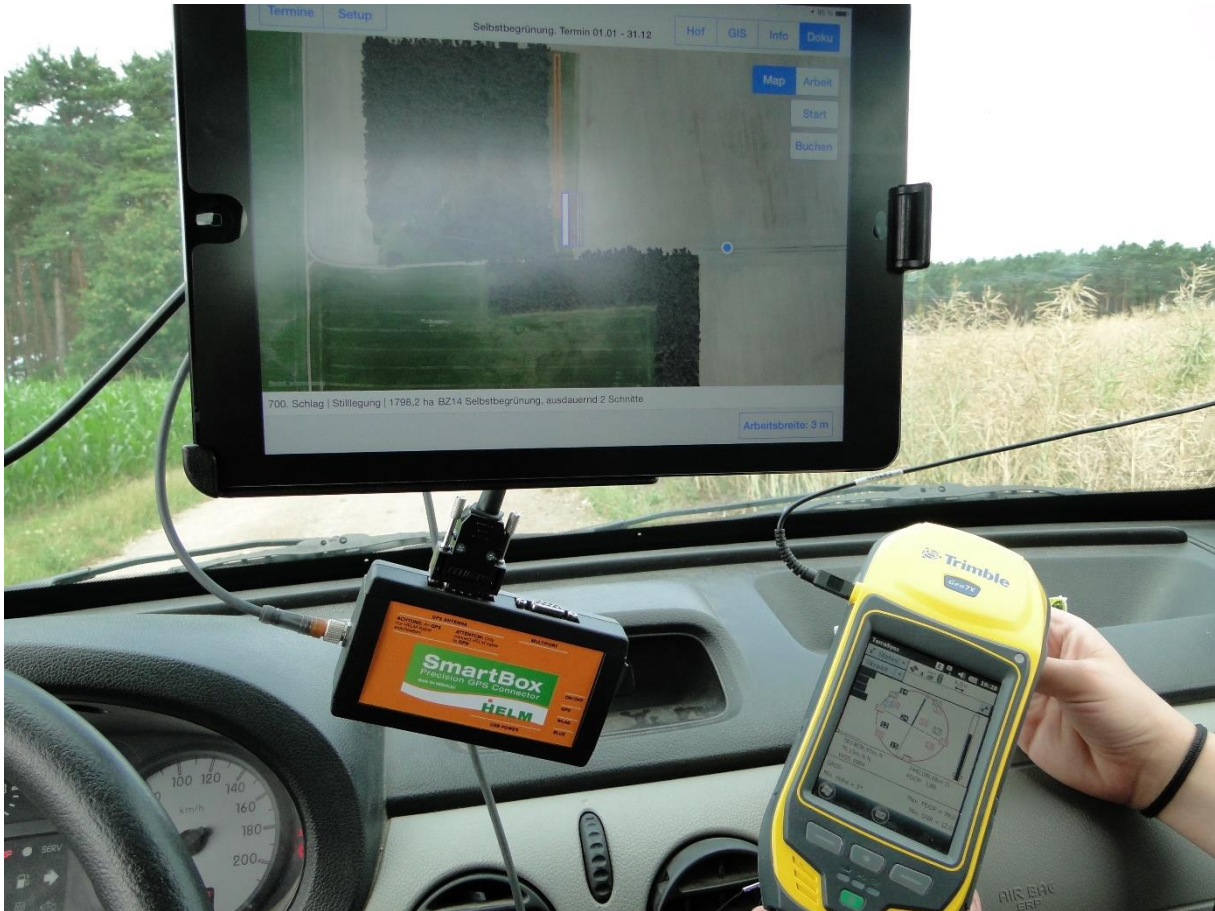
Abbildung 25: Versuchsaufbau mit iPad Air in Schlepperhalterung, WLAN-Router SmartBox der Firma Helm und dem Referenzmessgerät von Trimble
