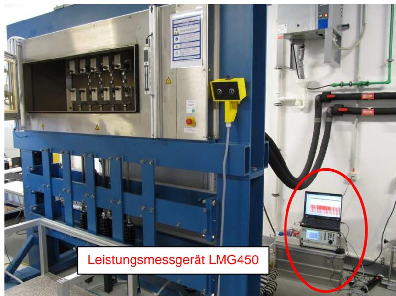
Abbildung 3-21: Energiemessung an der Kriechapparatur für SIM- und SSM-Versuche
