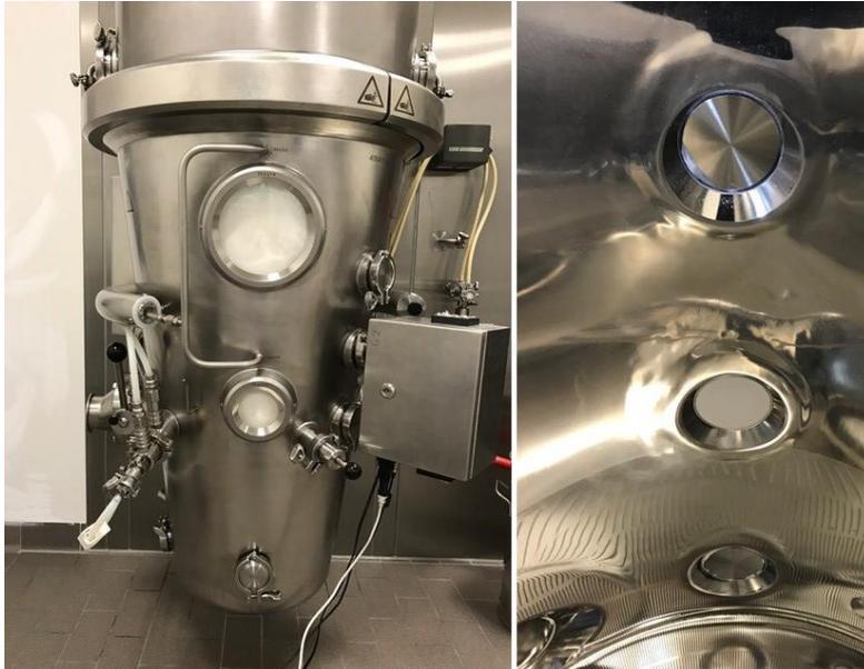
**Abb. 30: Außen- und Innenansicht des Bohle BFS 30 mit drei Ports.**
