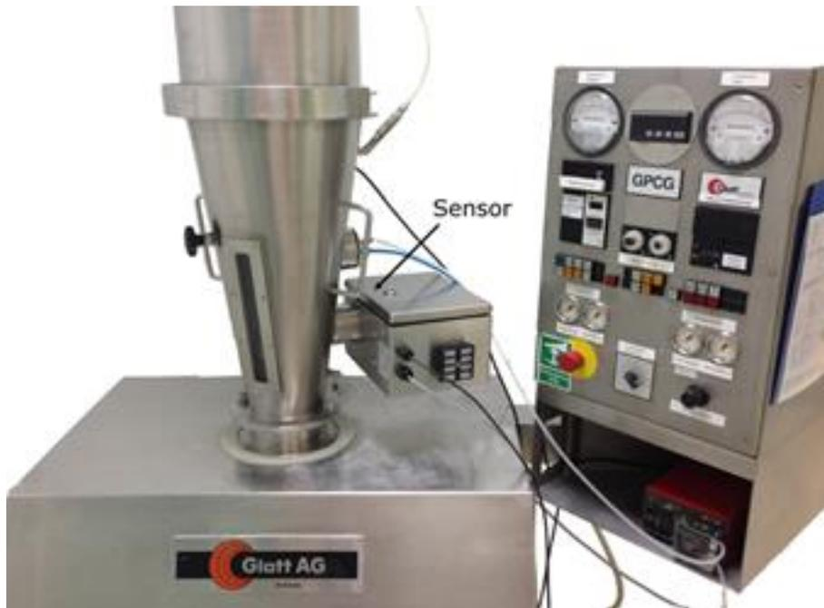
Abb. 23: Einbauposition des Sensors im GPCG1. (aus [22])
