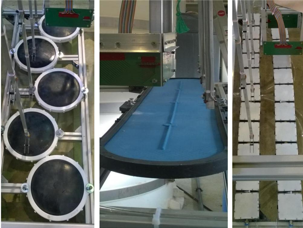
Abbildung 5.22: Installierte Teller-, Platten- und Kanülenbegaser (v.l.n.r) im Messgestell.
