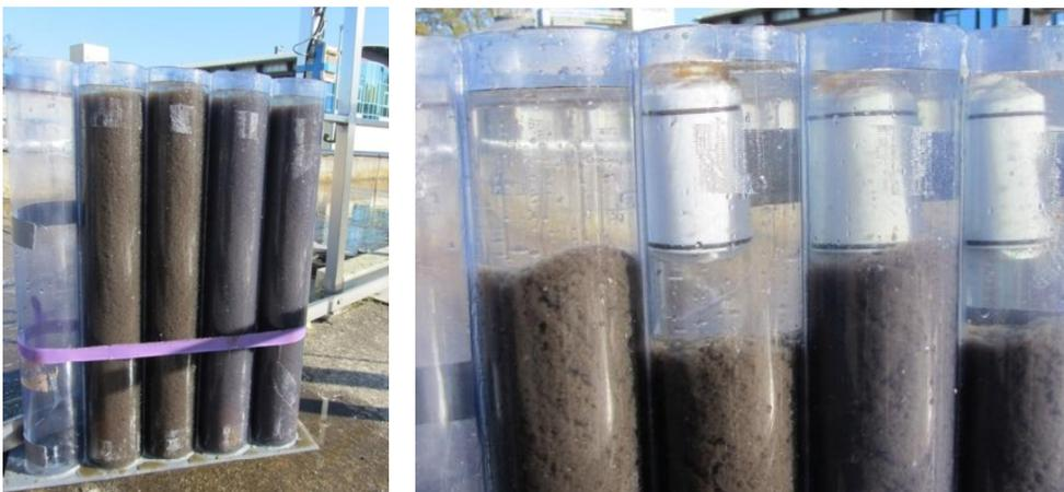
Abbildung 5.34: Automatische Tarierung der Strömungsfolger an der KA-Ebersbach vor der Zugabe in die Kläranlage: (Links) Abgesunkene Strömungsfolger mit eingefahrenem Hubkolben zu Beginn der Tarierung in den Probensäulen. (Rechts) Strömungsfolger nach dem langsamen Aufsteigen im quasi-auftriebsneutralen Zustand mit minimal ausgefahrenem Hubkolben
