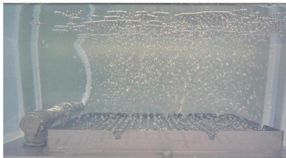
Abbildung 5.1: Kanülenbegaser der IWEB mit freistehenden Kanülen im Testbetrieb.
