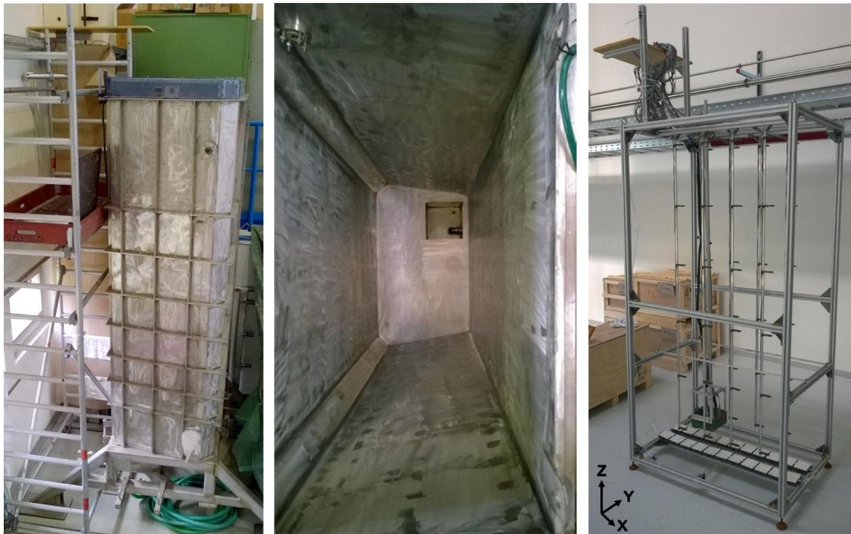
Abbildung 5.19: Labortank im Technikum des HZDR: (links) Seitenansicht und (mitte) Ansicht von oben. (Rechts) Messgestell mit Kanülenbegaser am Boden und dem installierten Gittersensor und den Punktsonden an den Lanzen für den Einsatz im Labortank.
