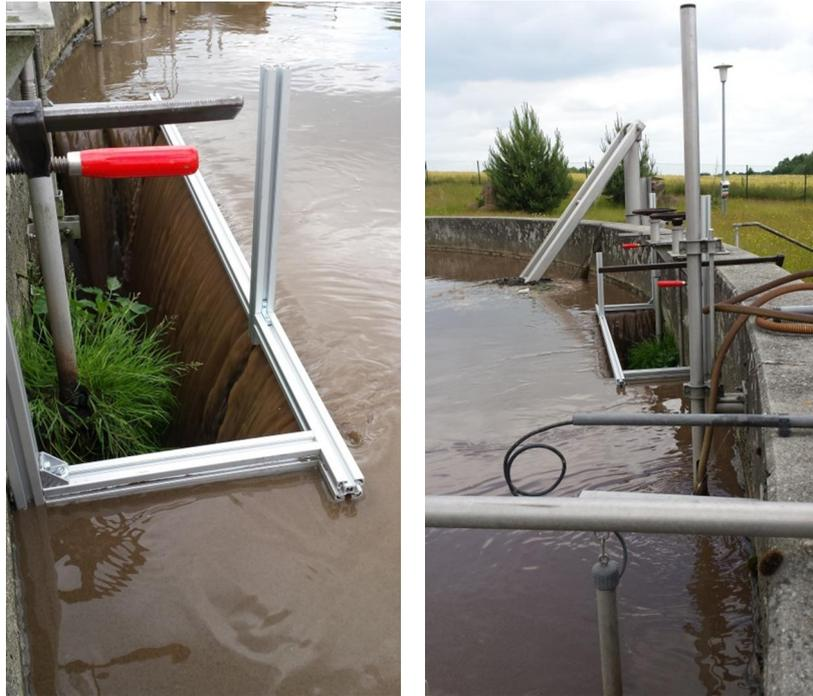
Abbildung 5.46: Barriere am Überlauf des Belebungsbeckens der KA-Großschweidnitz.
