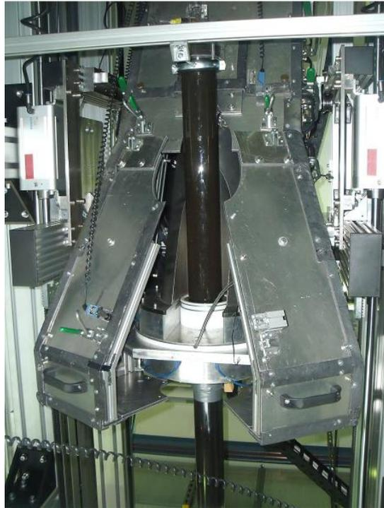
Abbildung 5.8: DN100-Messrohr während des Vorversuchs mit Belebtschlamm am Röntgentomograph ROFEX-I.
