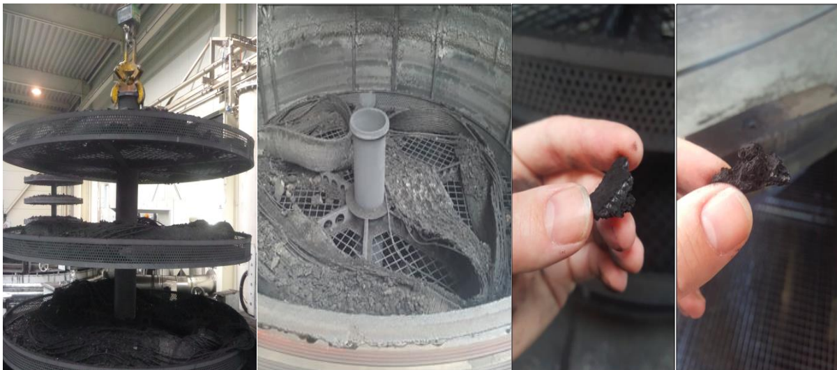
Abbildung 3-2: Rohcarbon und Stahl unmittelbar nach der Pyrolyse
