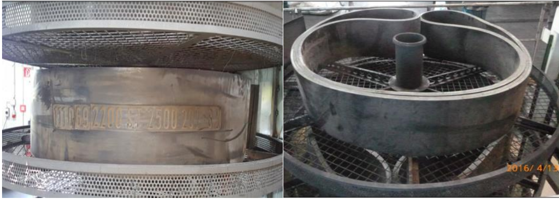
Abbildung 3-1: Pyrolysekörbe befüllt mit kompletten Stahlseilfördergurten.
