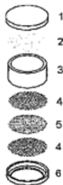
Abbildung 5.13 (links): Aufbau eines IVL-Passivsammlers
