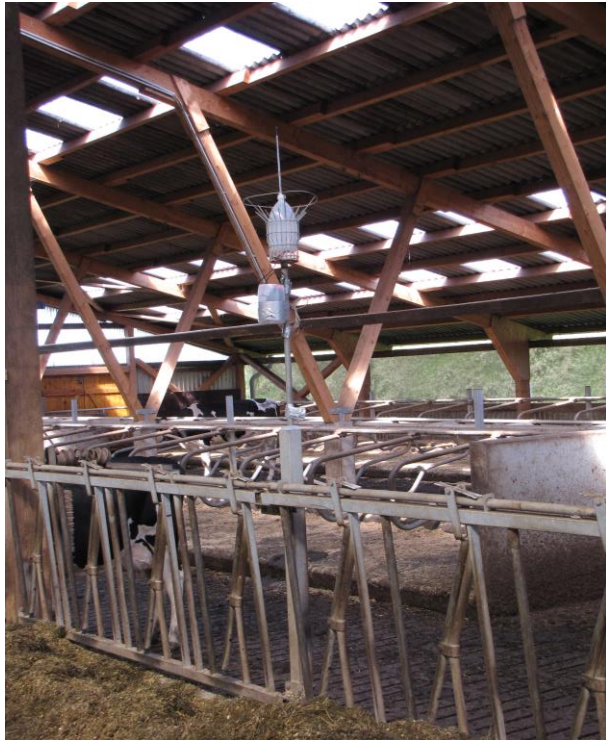
Abbildung 5.12: Hitzdrahtanemometer im Stall
