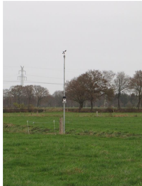
Abbildung 5.1: Messmast für Wettermessungen
