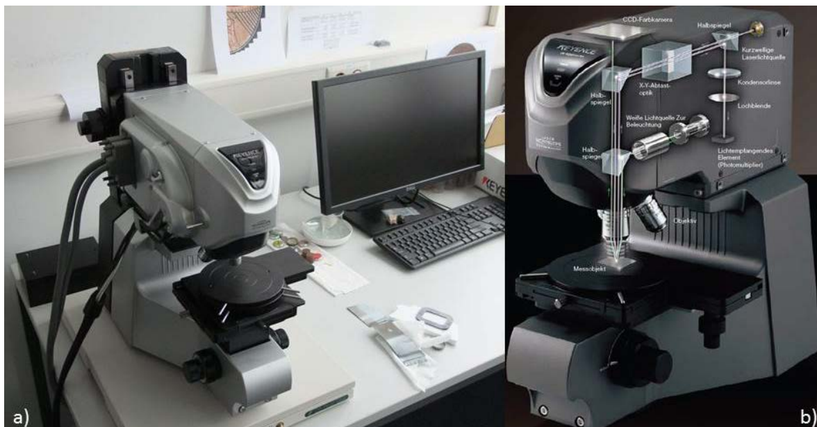
Abbildung 7: Laserscanningmikroskop mit Arbeitsplatz im CUTEC (a)), sowie dem inneren Aufbau zur Bilderzeugung (roter Laserstrahl (oben) und weißer Lichtstrahl (unten)) im rechten Bild (b)).
