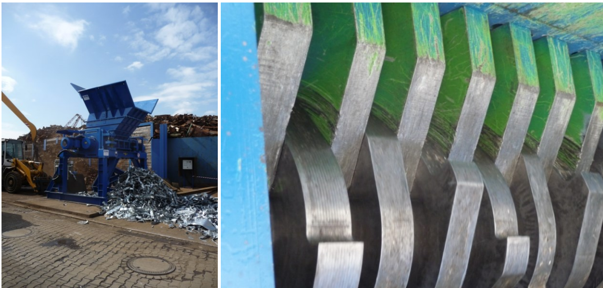
Abbildung 21: Rotorschere auf dem Gelände der RHM-Gruppe, rechts im Bild die Nahaufnahme des Schneidwerks der Rotorschere
