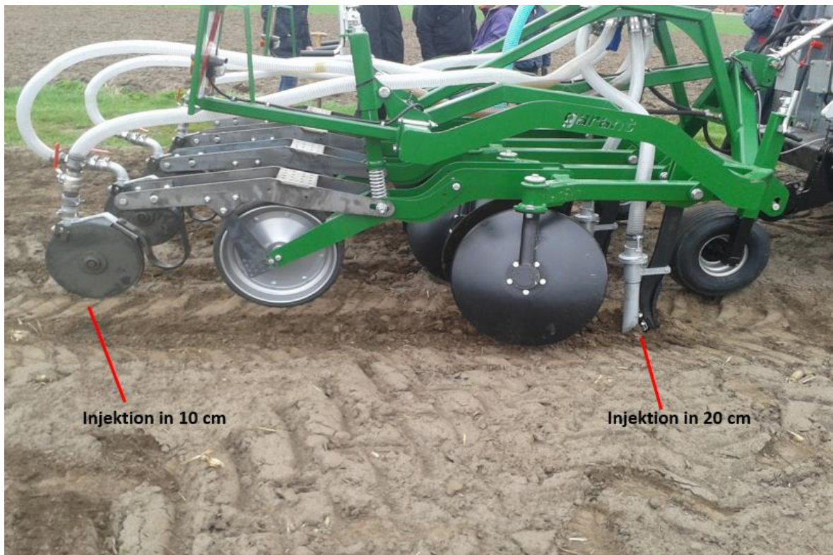
Abbildung 16: Der modifizierte „Kotte Premaister“ legt in zwei Tiefen (10 und 20 cm) übereinander zwei Güllebänder ab und soll somit die Nährstoffversorgung der Maispflanze in zwei Wachstumsphasen sicherstellen
