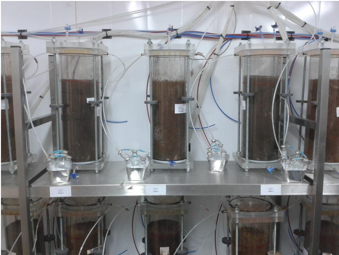
Abbildung 38: Mikrokosmenanlage mit Bodensäulen, Detailansicht
