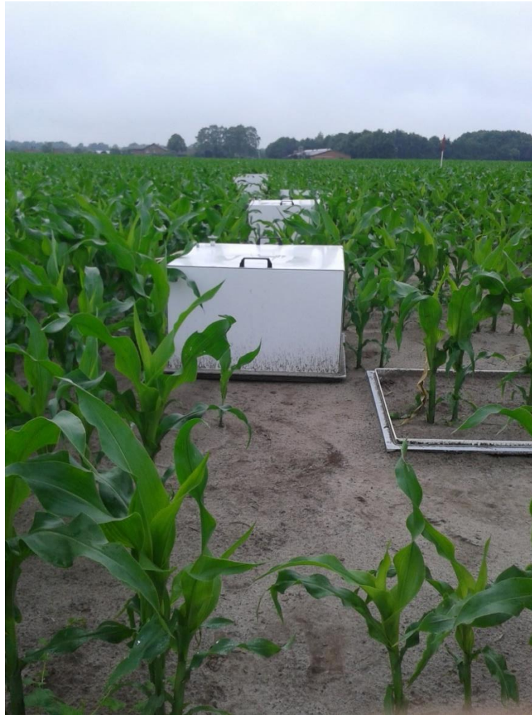
Abbildung 20: Die N 2 O-Probenahme erfolgt mit der Closed Chamber Methode
