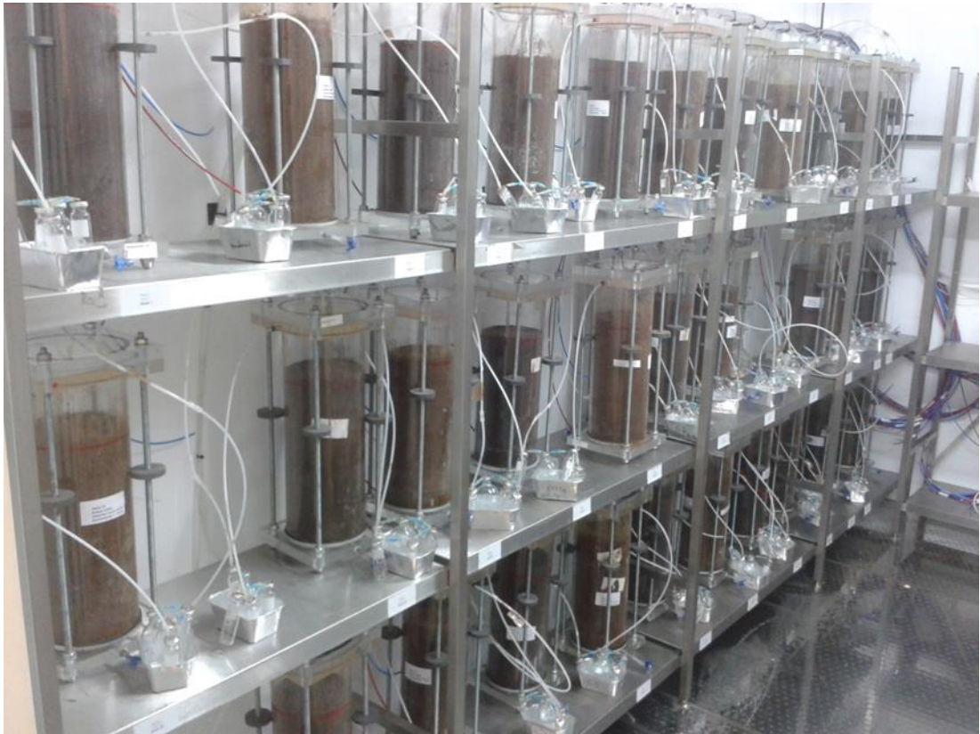
Abbildung 8: Mikrokosmenanlage mit Bodensäulen, Großansicht
