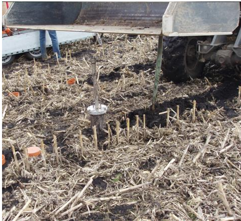
Abbildung 35: Probenahme von Bodensäulen mit einem Stechzylinder
