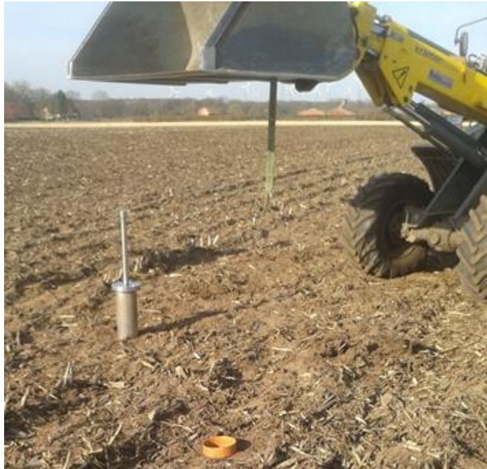
Abbildung 3: Probenahme von Bodensäulen im Stahlzylinder mit einem Radlader
