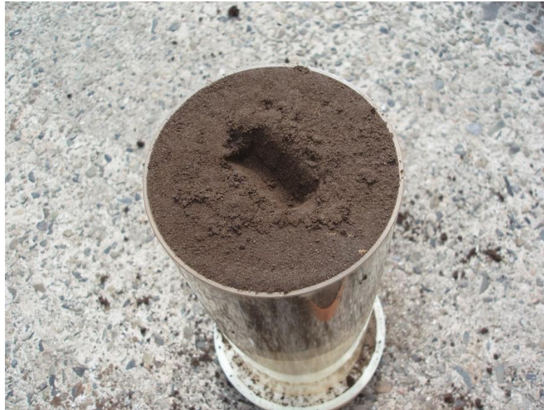
Abbildung 7: Injektionsfurche in der Bodensäule
