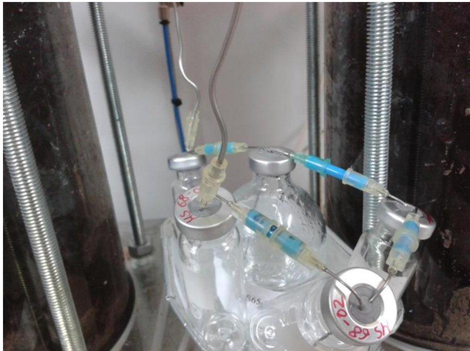
Abbildung 9: Glasvials für N_2O , CH_4 und CO_2 sowie ein großes Vial als Säurefalle für NH_3
