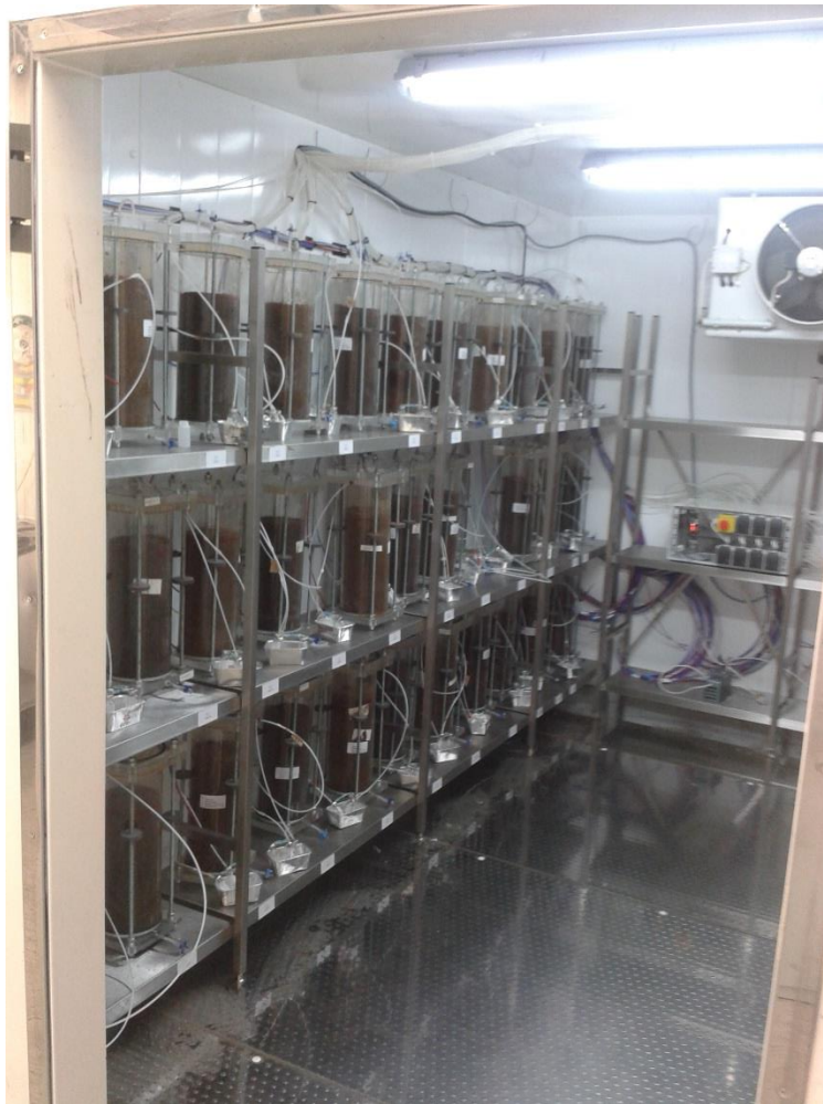
Abbildung 39: Mikrokosmenanlage mit Bodensäulen
