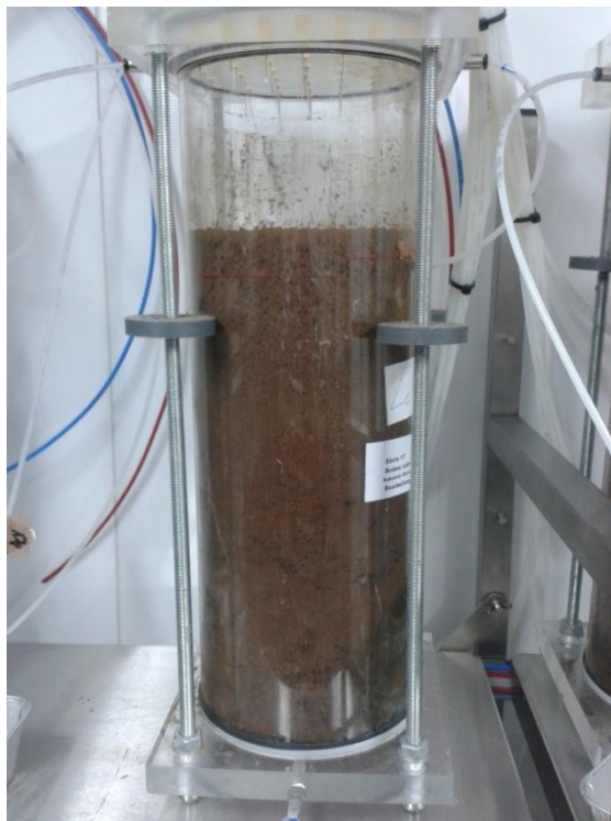
Abbildung 4: Bodensäule im Mikrokosmengerüst in der Klimakammer
