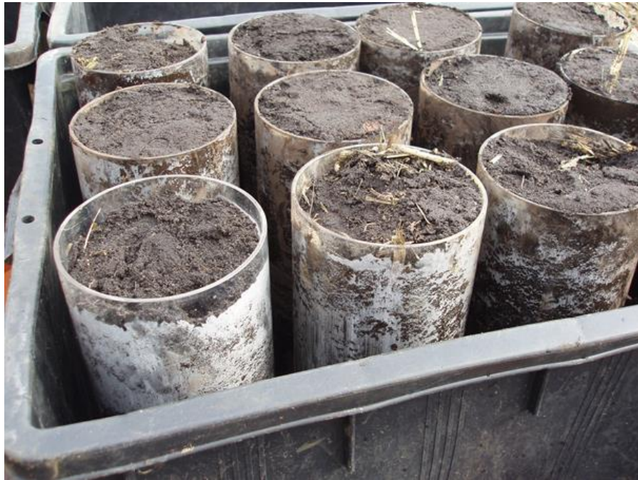
Abbildung 36: Unbearbeitete Bodensäulen direkt nach der Probenahme
