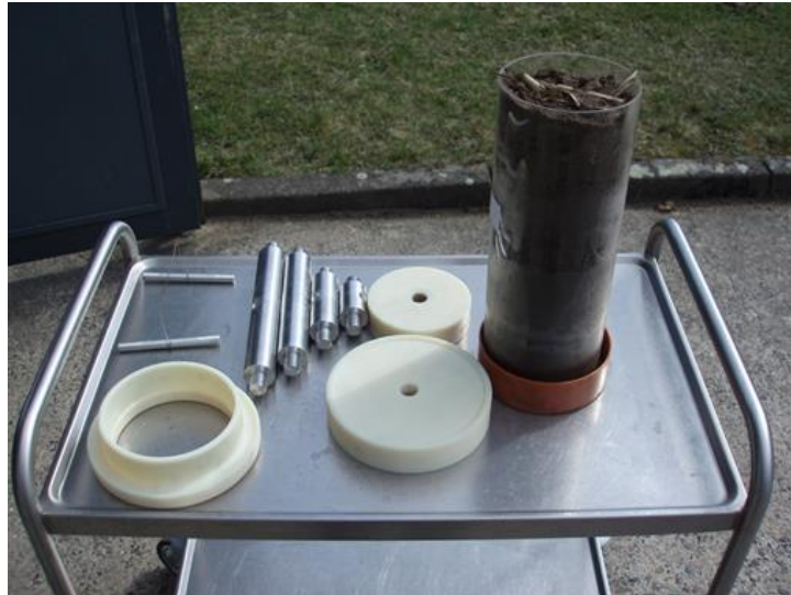
Abbildung 5: Stempelsystem zur Bearbeitung von Bodensäulen
