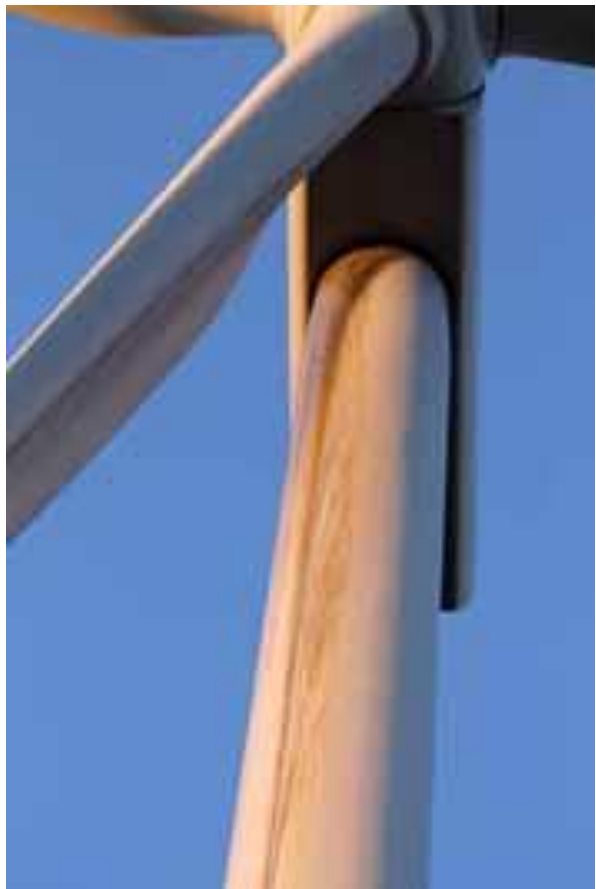
Bild 1: Ölunfall an einer Windenergieanlage
