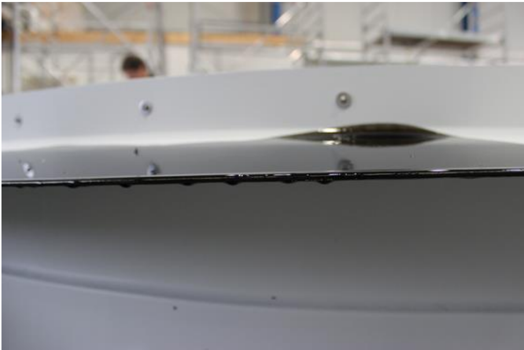
Bild 22: Ölfluss über den Ölabweiser
