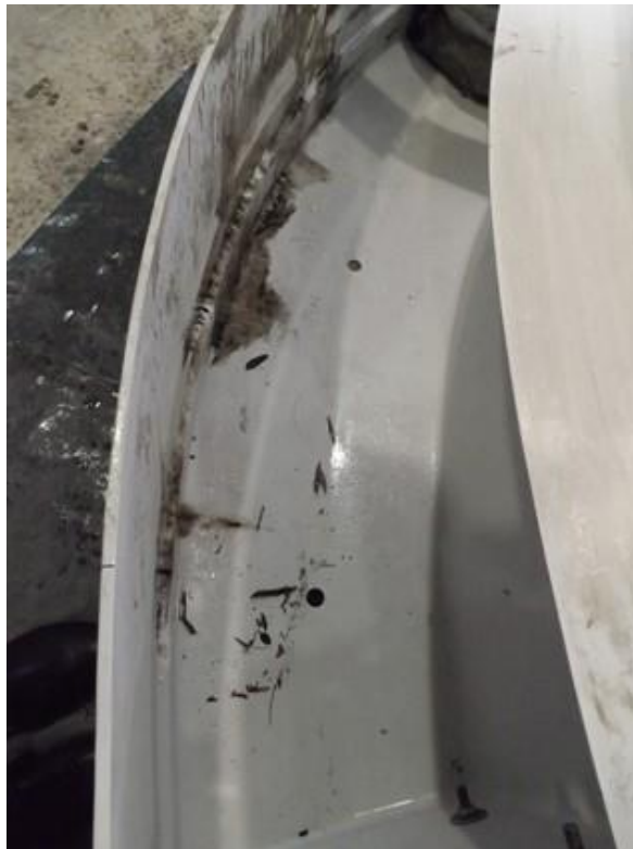
Bild 26: Restölfilm auf dem OSC Gehäuse
