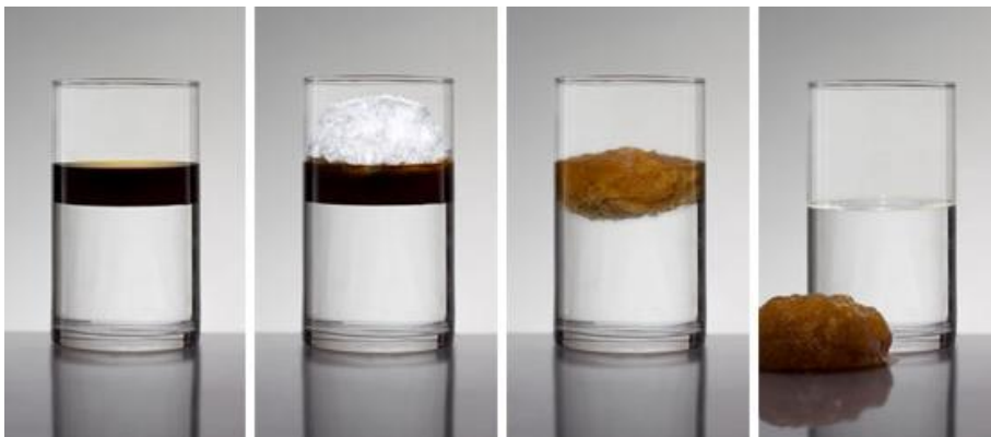
Bild 15: Aufnahme von Altöl mittels DEUREX PURE
