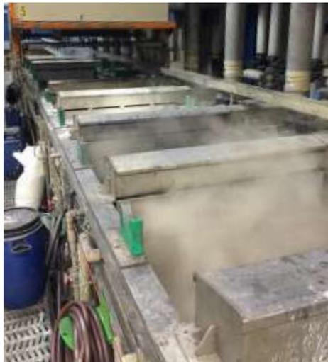
**Abbildung 3: Phosphatieranlage der Schondelmaier GmbH Presswerk**
