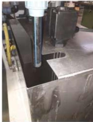
Mehrkammersystem zur Öl- und Partikelabscheidung sowie zur Erwärmung des Reinigungsmediums
