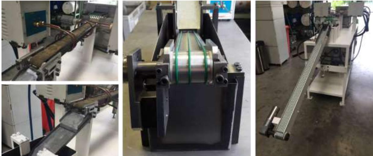
**Abbildung 21:** Erwärmungseinheit (oben links) mit Teilerutsche (unten links), Transportband durch das Beschichtungsmedium (Mitte) und Förderband zur Verkettung mit Umformpresse (rechts).
