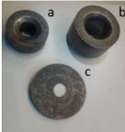
**Abbildung 9: a+b+c - Ringförmige Rohteile der Schondelmaier GmbH Presswerk
