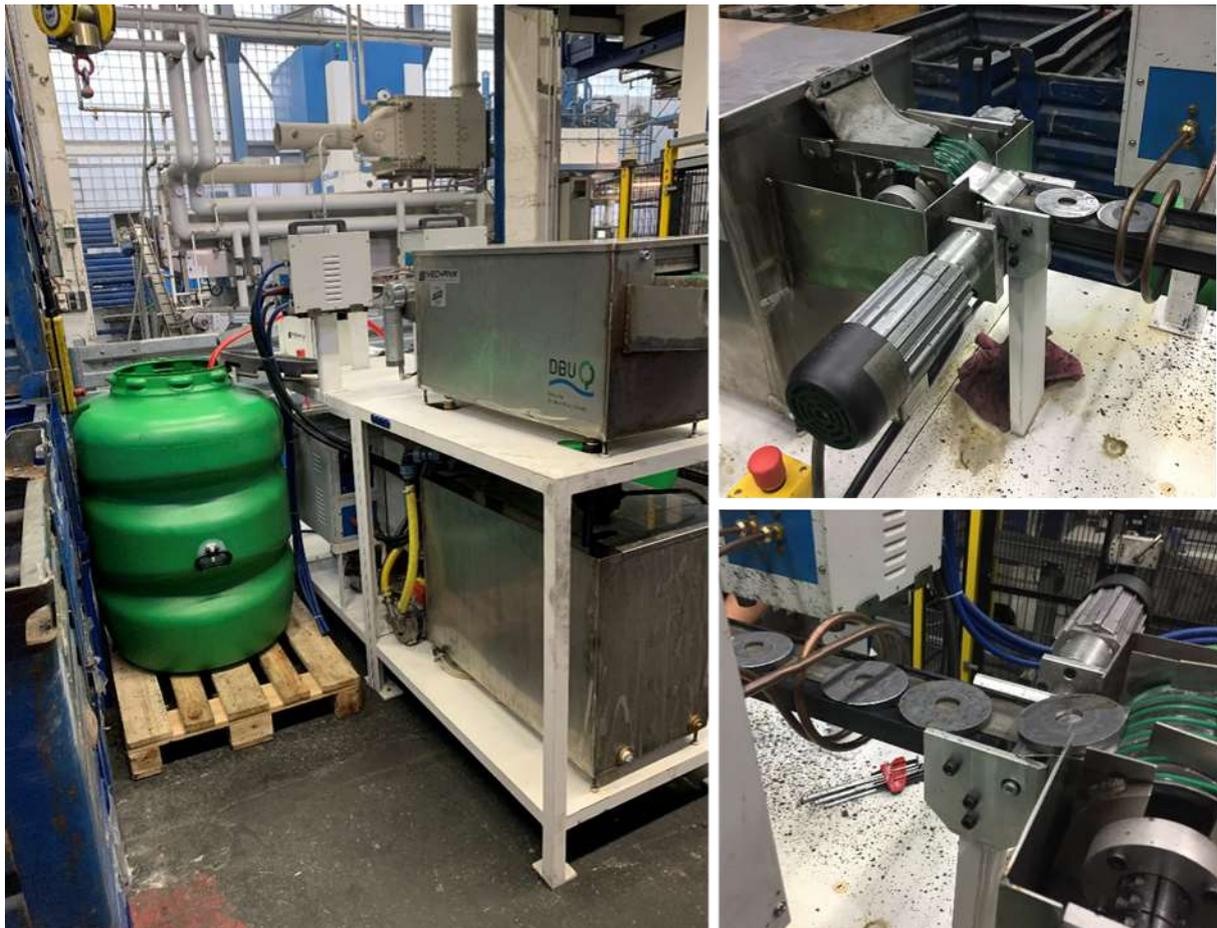
**Abbildung 28: integrierte Beschichtungsanlage mit Pressenzuführung im Hintergrund (links) und Reinigungs- und Erwärmungseinheit im Dauerbetrieb (rechts, oben und unten).**
