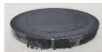
**Abbildung 17: Gleitstauchversuche zum Einfluss der Beschichtungshomogenität (links) und Umgeformte MoS<sub>2</sub> Gleitstauchprobe mit ablösender Beschichtung der Mantelfläche (rechts)**
