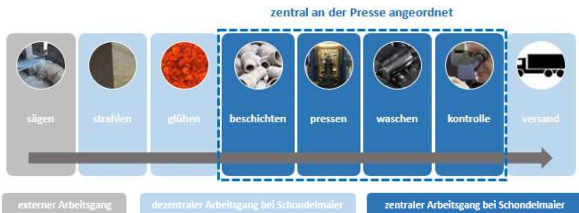
Abbildung 32: Neue Prozesskette in der Kaltmassivumformung.
