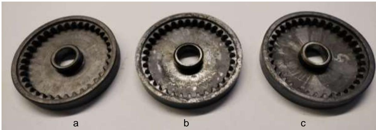
**Abbildung 31: Sicht auf Verzahnungsbereich der Pressteile; a=Serienteil ZnPh+MoS<sub>2</sub> , b=7,3% MoS<sub>2</sub>, c=5%MoS<sub>2</sub>**
