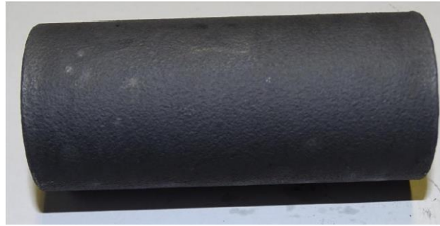
Abbildung 26: Mit MoS 2 beschichtetes Bauteil
