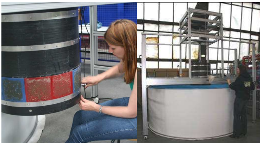
Abbildung 16: Anbringen von gebogenen Testflächen an den Rotationszylinder (links), Absenken des Zylinders ins Wasserbecken zur Dauerbeprobung (rechts).
