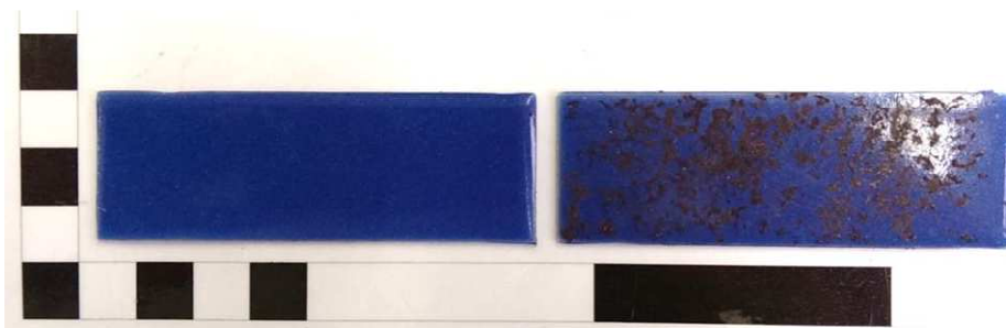
Abbildung 21: Auslagerungspanels SeaLifeHab, rechts: Bewuchs durch Mikro-Algen nach ca. 12 Wochen im Versuchsbecken.
