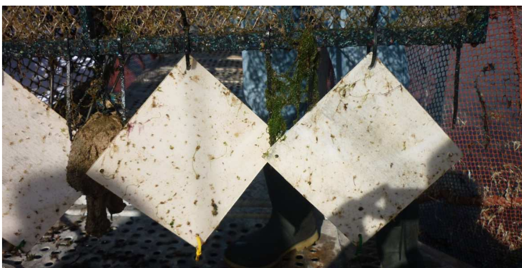
Abbildung 22: Erste Zwischenergebnisse der Bewuchskontrolle der Testflächen, die in Fischfarmen in Chile ausgelagert wurden. Erkennbar weisen die Platten eine sehr niedrige Bewuchsdichte auf.
