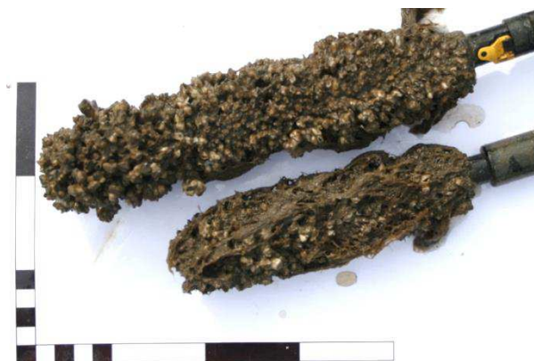
Abbildung 6: Starke Inkrustation durch Seepocken auf der Sauerstoff- und pH-Messsonde des WTW-Messgerätes nach 8 Wochen Expositionszeit. Diese zeigen den starken Bewuchsdruck im beprobten Habitat auf.
