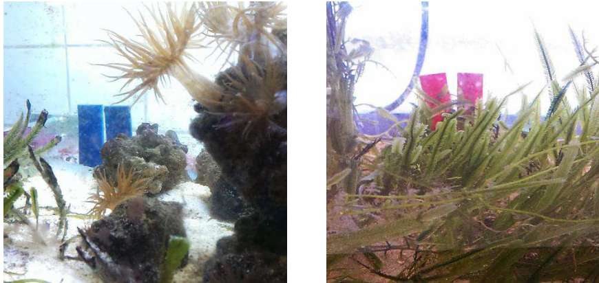
Abbildung 20: Meerwasserhabitate des SeaLifeHabs mit Probeträgern (hier: Haihaut = Silikon mit Poraver®-Partikeln).
