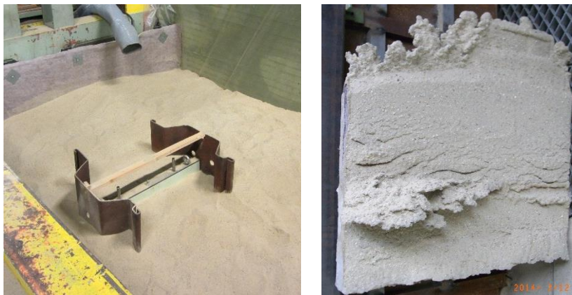
Abbildung 6-2: Vorbereitung des Laborversuchs (links) und freigelegter Injektionskörper (rechts)
