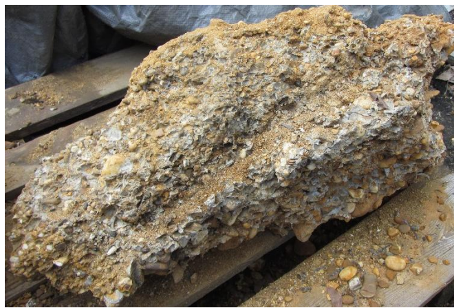
Abbildung 6-6: Probe des Injektionskörpers der zweiten Versuchsreihe
