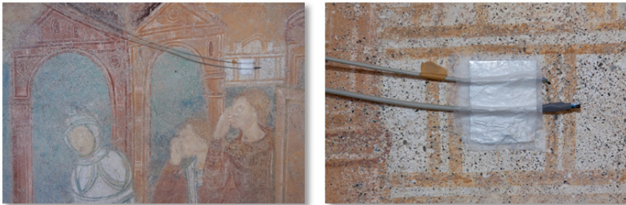
Bild 2 links: Messsonden zur Erfassung von Oberflächen- und Nahfeldklimaten in der Bildszene der Erweckung des Lazarus in St. Georg auf der Insel Reichenau rechts: Detailaufnahme der Messsonden (Januar 2012, Foto Dörthe Jakobs)
