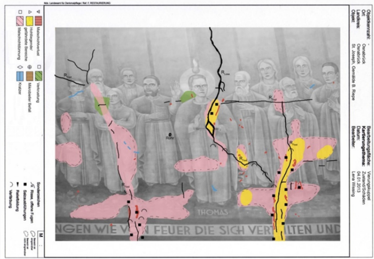
Bild 4 Zustandskartierung am Beispiel der Vierungskuppel
