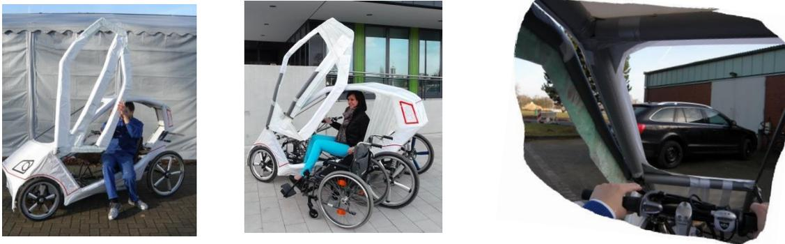
Abbildung 9 Test Einstieg "normal" und Ausstieg aus dem Rollstuhl, Sichtfeldanalyse und Lenken
