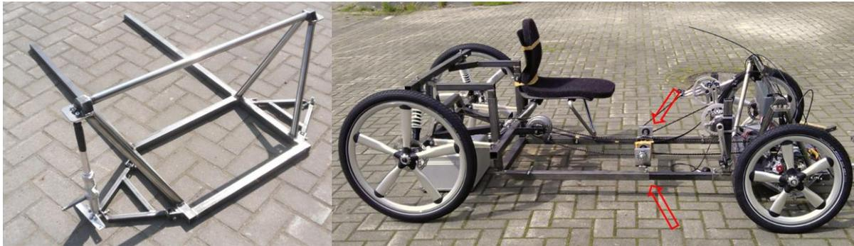
Abbildung 25: Bodengruppe AGT, links Vorderteil, rechts Zusammenbau Vorder-und Hinterteil
