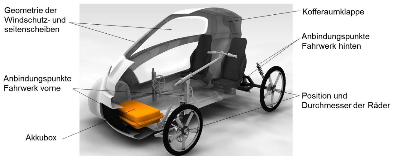
Abbildung 5: Darstellung der Designrelevanten "hard points"
