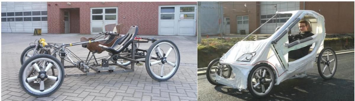
Abbildung 26: AGT, links: fahrbereiter AGT, rechts: AGT mit einseitiger Außenhülle
