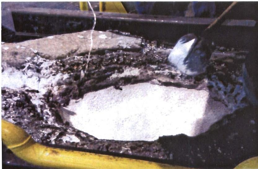
Abbildung 29: Abdeckung der Schmelze mit BUBBLES (Thermoelement von oben links)
