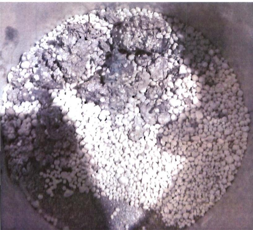
Abbildung 32 : Restmaterial der Abdeckung nach dem Absaugen (Alu-Klumpen entstanden durch Abkrätzen)
