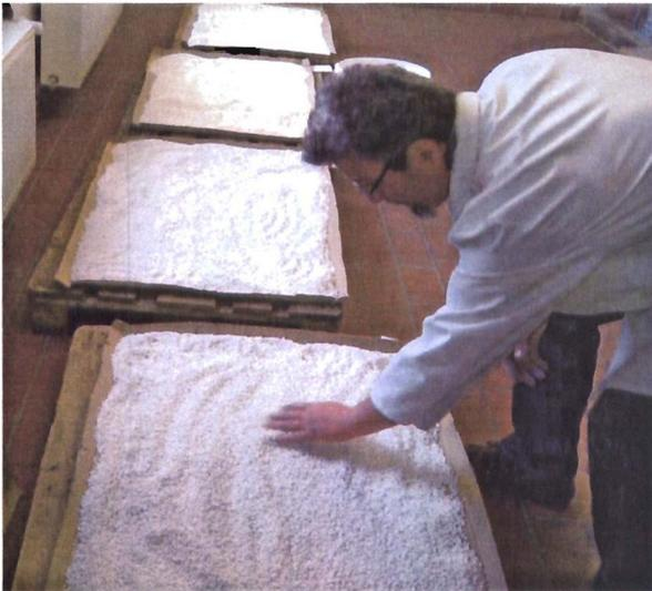
Abbildung 11 : Trocknung der beschichteten OMEGA-BUBBLES
