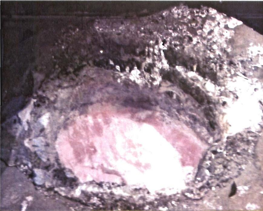
Abbildung 31 : abgesaugte Schmelzbad Oberfläche (nachgereinigt durch Abkrätzen)
