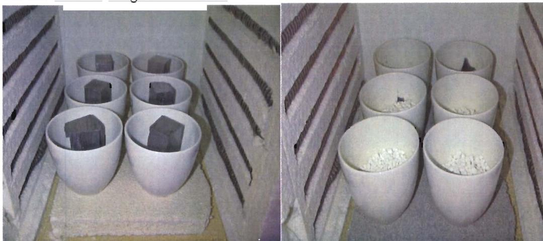
Abbildung 8: Kontaktierung der Schmelze im Laborofen
