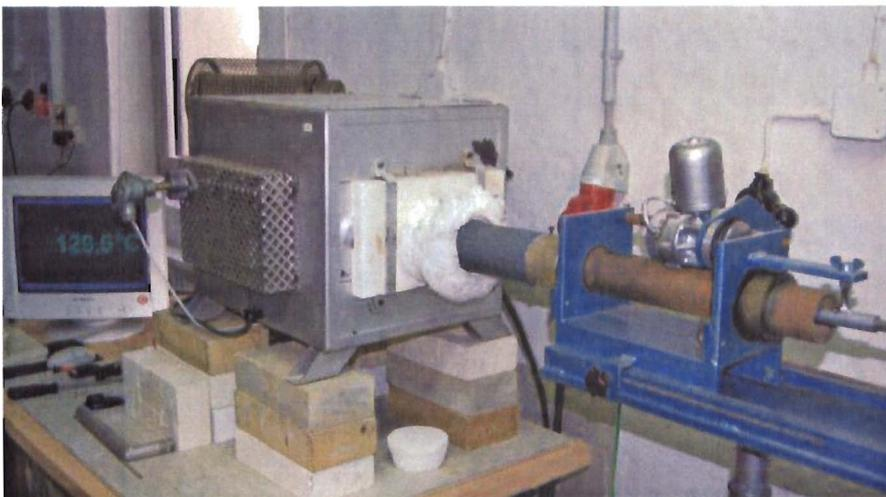
Abbildung 3: Labordrehrohrföfen mit Messtechnik
