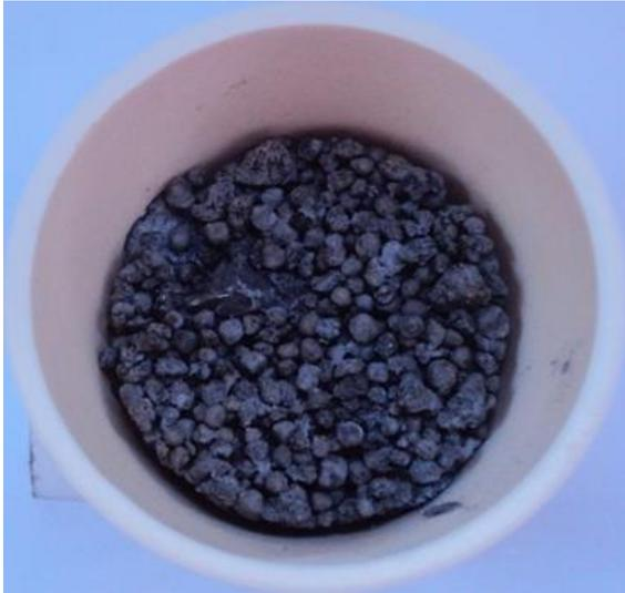
**Bild 24:** Grünkorn-Granulat mit Zucker bei 850 °C auf der Alu-Schmelze
