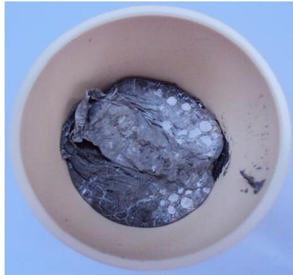
**Bild 23:** Entfernen des gecoateten Granulates von der Alu-Schmelze
