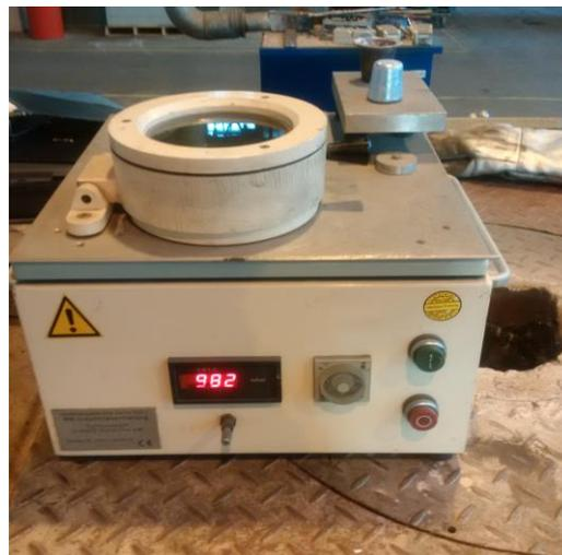
**Bilder 49 + 50** Vakuum-Prüfgerät zur Bestimmung des Dichte-Index der Legierung
