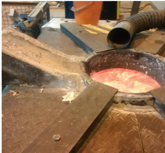
**Bild 48:** Induktionstiegel-Ofen (100 kW)
