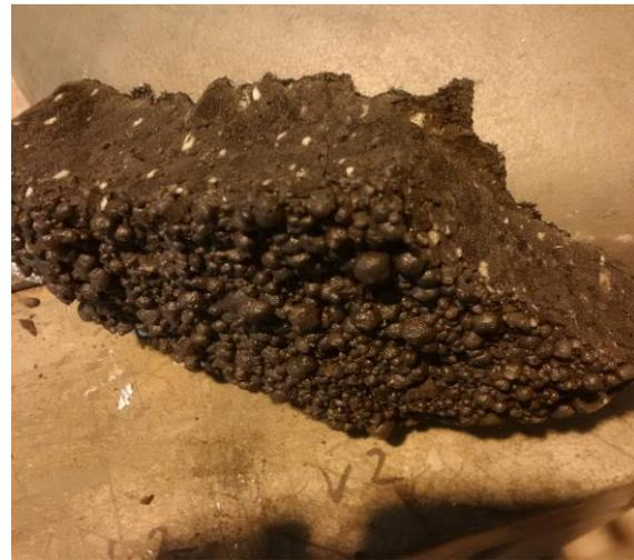
**Bild 38:** Bruchfläche der Schaumplatte
