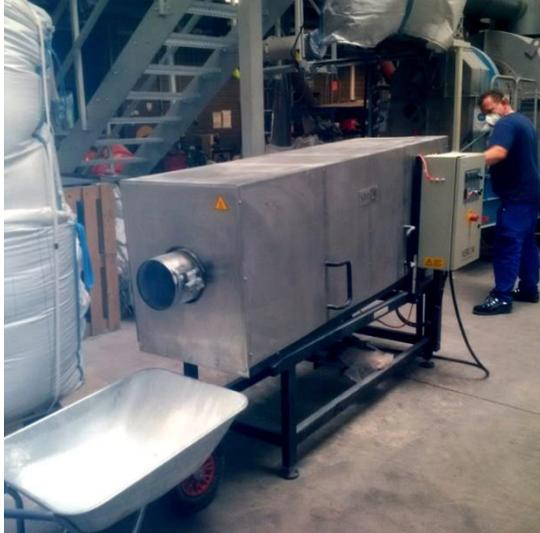
**Bild 8:** Sintern der Coatingschicht bei 600 °C
