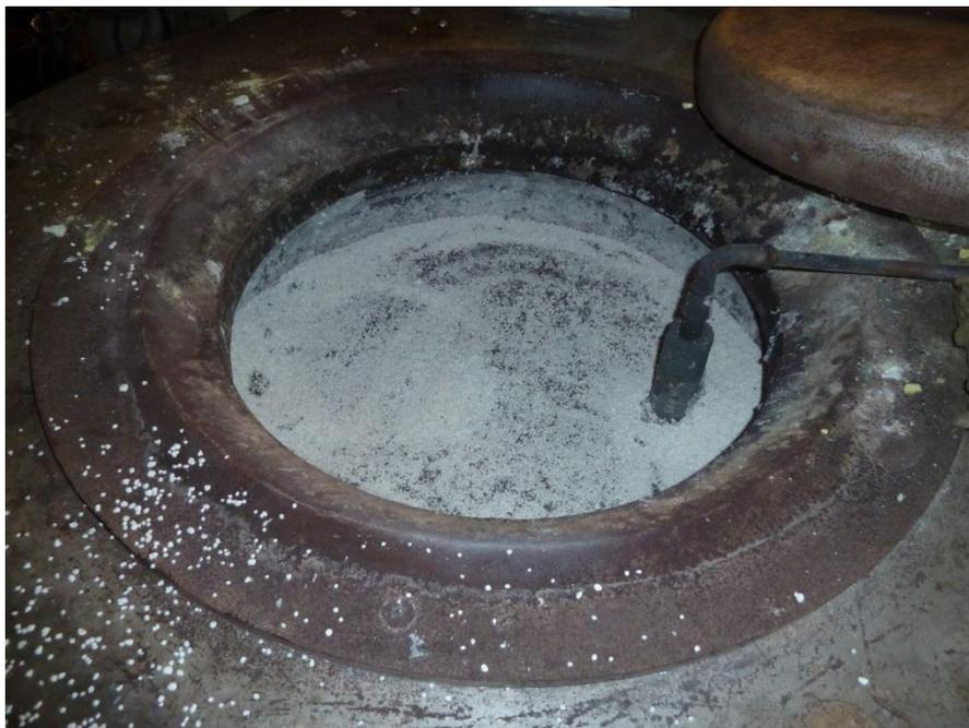
**Bild 20:** Als Glasplatte ausgebildete Schicht nach Abräumen der Granulate
