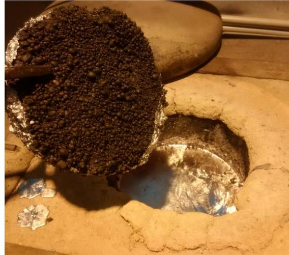
**Bild 36:** Schaumplatte nach dem Austrag (obere Ansicht und Randbereich)
