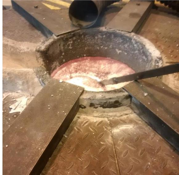
**Bild 14:** Abkrätzen Metallbad-Oberfläche
