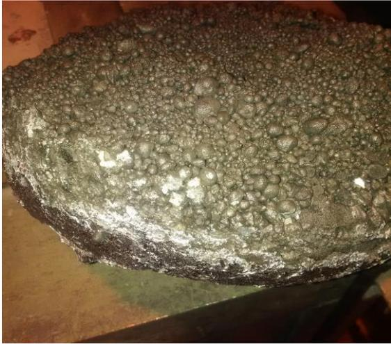
**Bild 35:** Austrag der Schaumplatte nach 4 Std. Abdeckzeit (verkohlt)
