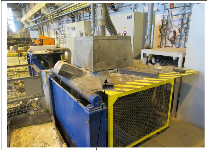
**Bild 17:** stationäre Absaughaube über dem Tiegelofen zur Absaugung der Rauchgase
