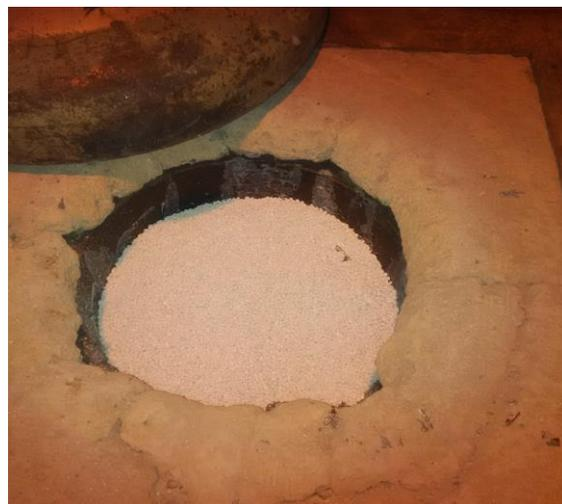
**Bild 34:** Abdeckung der Alu-Schmelze bei 750 °C Kontakttemperatur
