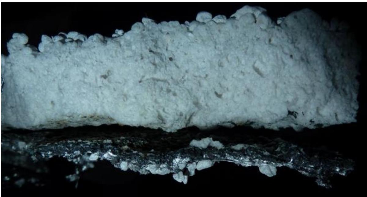
**Bild 41:** Schaumschicht ohne Glasplatte über erstarrter Aluminiumschmelze
