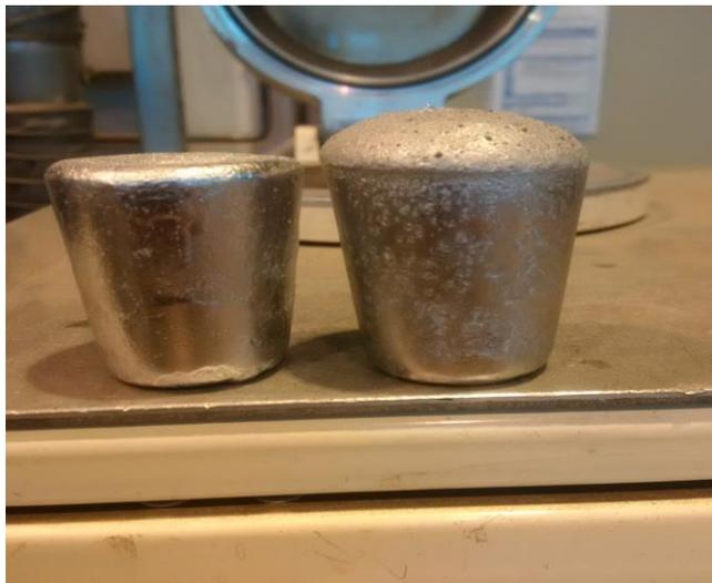
**Bild 18:** Alu-Proben (links in Luft, rechts in Vakuum)
