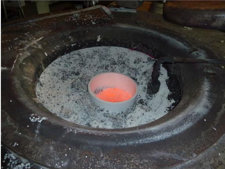
**Bild 51:** Ring aus Kalziumsilikat zur Probenentnahme
