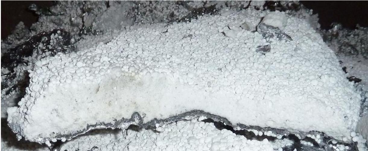
**Bild 42:** Schaumschicht über erstarrter Glasplatte
