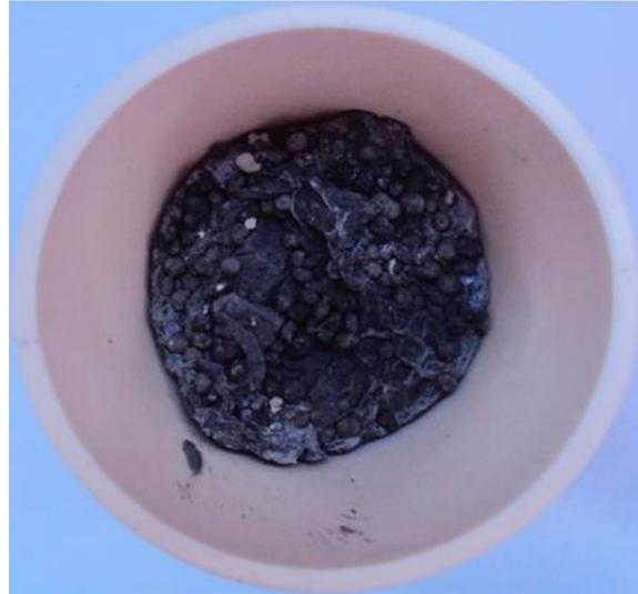
**Bild 25:** Entfernen der Schaumschicht von der Alu-Schmelze
