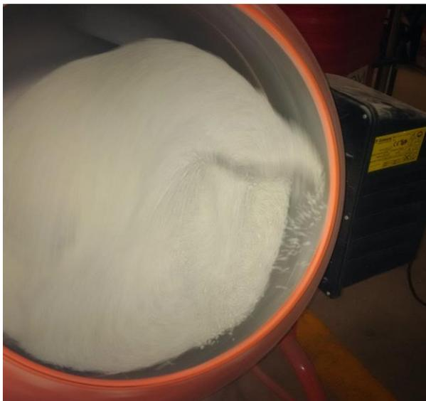
**Bild 6:** Trommelmischer mit Granulat
