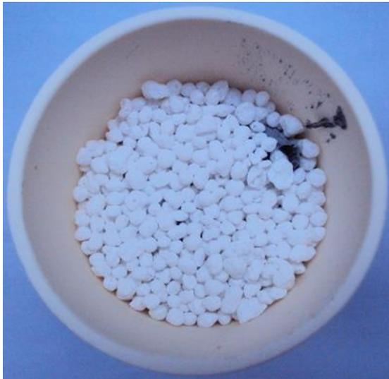
**Bild 22:** Gecoatetes Granulat bei 850 °C auf der Alu-Schmelze
