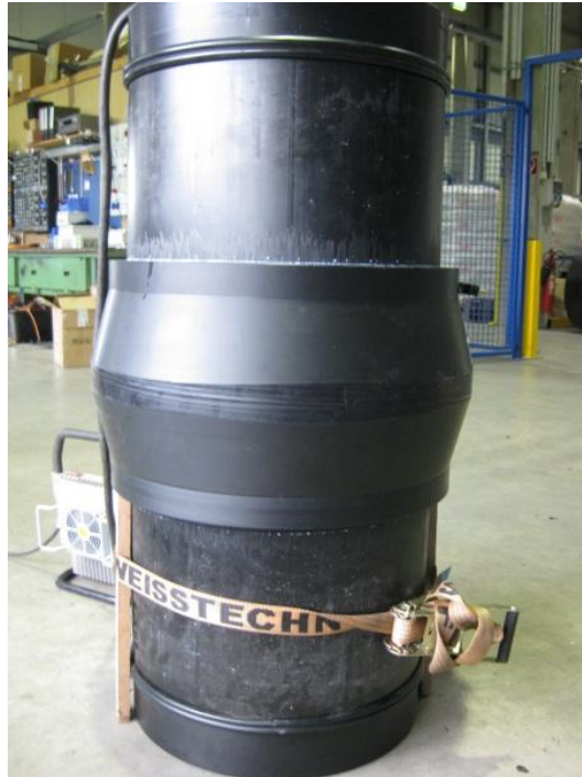
Abbildung 3-37: Prüfaufbau Muffe D560
