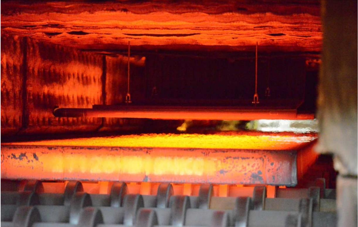
Bild 2: Blick auf den Brammenrollgang mit Bramme und Wärmetauscher
