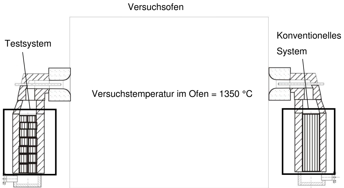
Bild 14: Versuchsaufbau zum direkten Vergleich des neuen Systems mit einem konventionellen System
