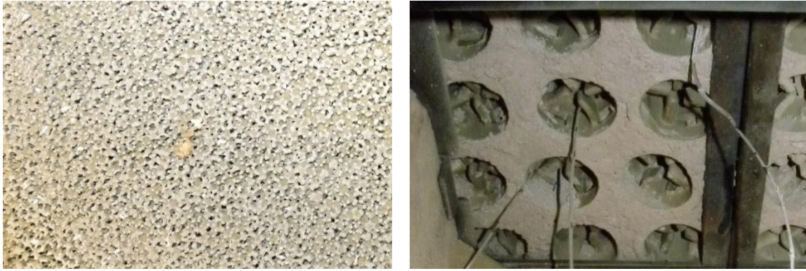
Abbildung 12: Schaumplatten aus Nichtoxidkeramik (links) sowie Füllkörper-Module (keramische Pall-Ringe, 50 mm) nach der thermischen Regenerierung bzw. während der Regelbetriebsphase eines Kaminofens.
