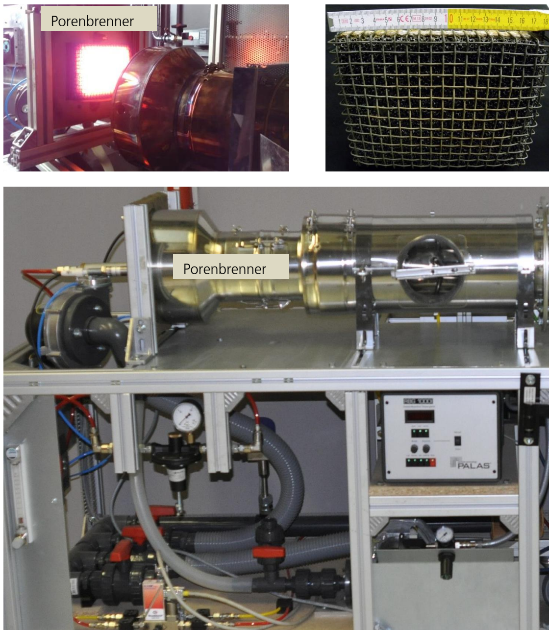
Abbildung 3: Aufbau des Porenbrenners im Abgassimulator, Brennerkopf (oben links im Betrieb, oben rechts nicht im Betrieb).
