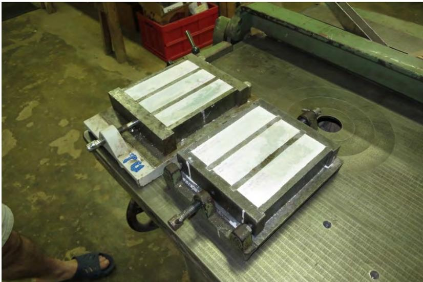
*Bild 99. Mörtelprismen zur Prüfung der Druckfestigkeit und der Biegezugfestigkeit*
