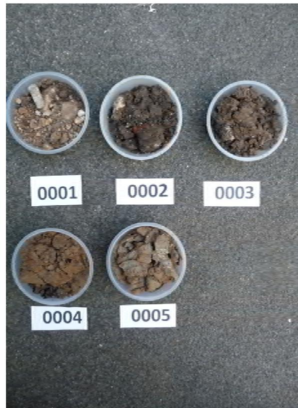
Bild 286. Probendosen mit Kennzeichnung des Entnahmehorizontes
