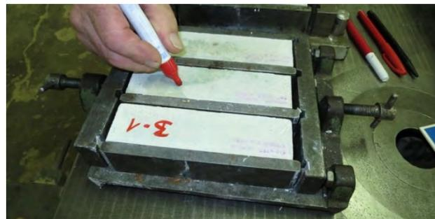
Die anzumischende Menge Verpressgut richtet sich nach dem jeweiligen zeitlichen Bedarf. Das Anmischen erfolgt unter genau vorgeschriebener Wassermengenzugabe (s. Bild 107). Bild 108 zeigt die hergestellten Rückstellproben in Form von Prüfprismen hier noch in der Stahlschalung.
