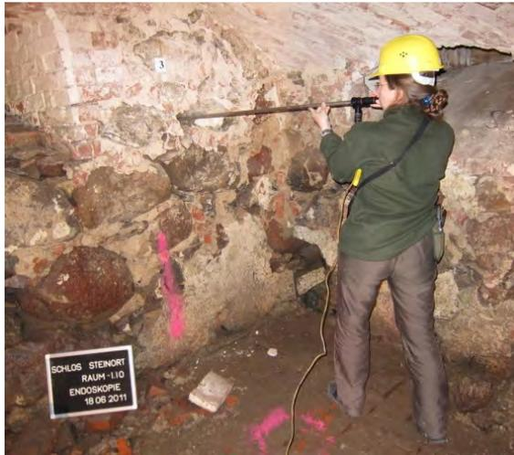
Bild 77. Endoskopie des Kellermauerwerks im NW-Turm zur Erkundung der inneren Struktur
